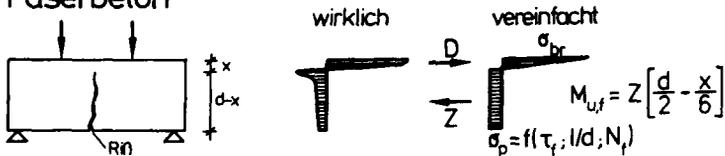
**Bild 4.47:** Bruchspannungsverteilung am Biegebalken aus Normal- bzw. Faserbeton
