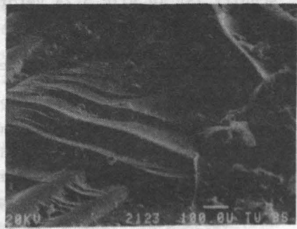
Bild 5.26: Detailaufnahme mit teilweise freiliegenden Fasern
