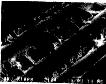
Bild 2.1a: Geätzte Staboberfläche REM-Aufnahme; Vergrößerung 700 x
