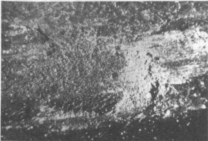
Bild 48 Oberfläche des glatten Rundstahls nach einem Ausziehversuch bei Raumtemperatur. Weiße Flecken: anhaftende Rückstände aus Hydratisationsprodukten. Vergr. 6-fach.
