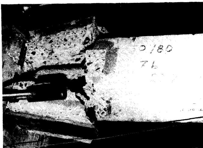
Bild 4.9: Bruchbild eines Laschenkörpers bei Klebung der Laschen parallel zur Ebene der inneren Bewehrung (1. Abwandlung)
