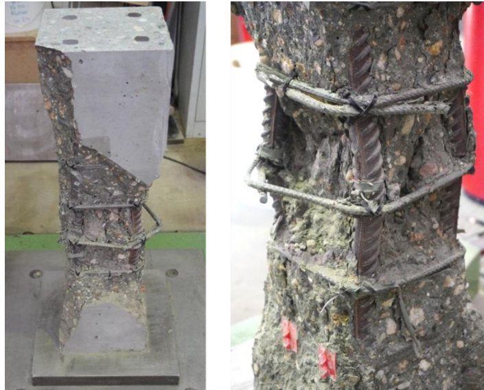
Bild D-9: Stütze Q-1 nach dem Bauteilversuch
