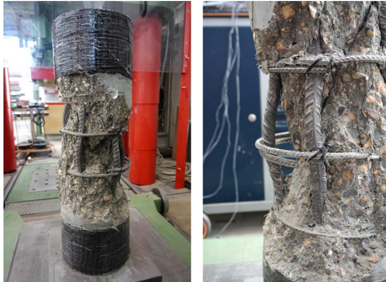
Bild D-13: Stütze K-1 nach dem Bauteilversuch
