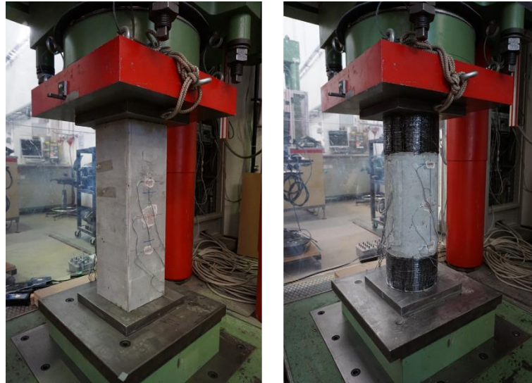
Bild D-5: Stütze Q-1 (links) und K-2 (rechts) in der 10 MN-Prüfmaschine
