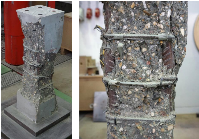
Bild D-10: Stütze Q-2 nach dem Bauteilversuch
