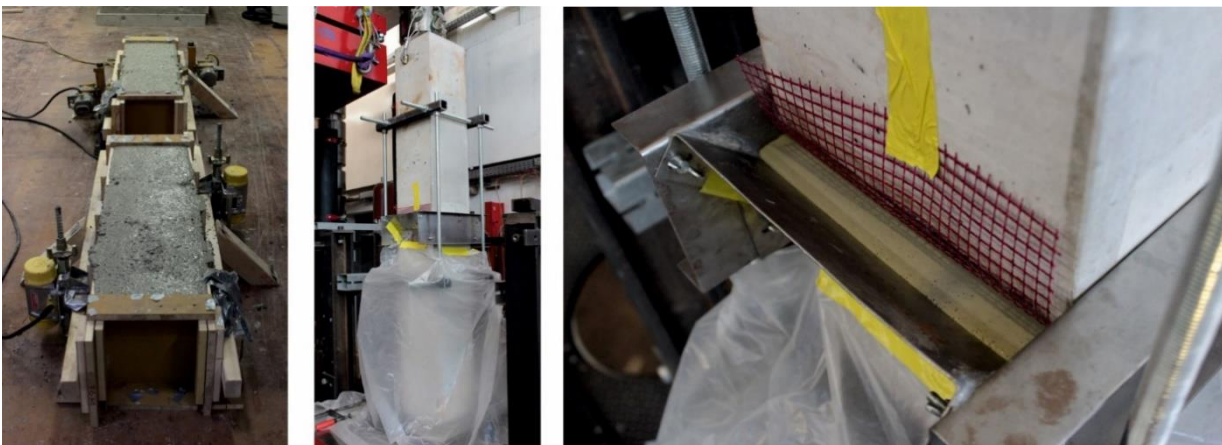
Bild 8-2: Betonage der Stützenabschnitte (links), Gestell zur Einstellung der Mörteldicke (Mitte) und Vermörtelung des Stumpfstoßes (rechts) am Beispiel von S 9.3
