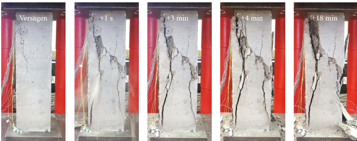
Bild D-8: Versagen der Stütze Q-2
