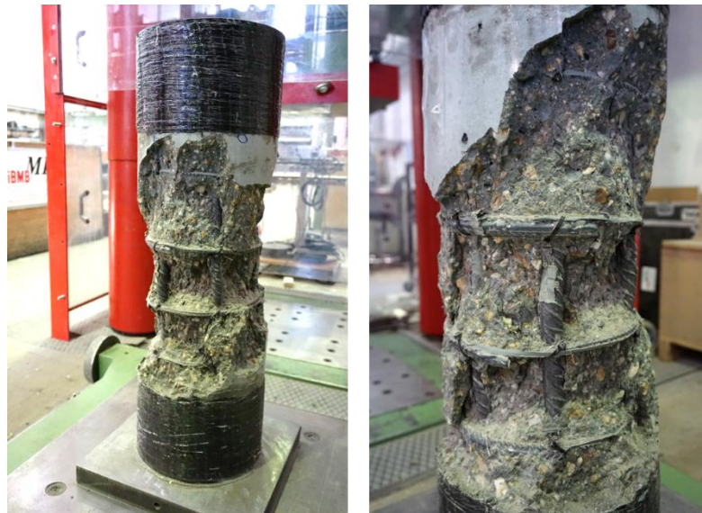
Bild D-14: Stütze K-2 nach dem Bauteilversuch
