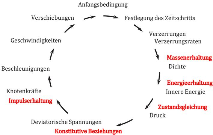
**Abb. 6-8:** Bei der expliziten Zeitintegration je Zeitschritt und Diskretisierungsort durchlaufenes Rechenschema, in Anlehnung an [Nö10] nach [Hi08]
