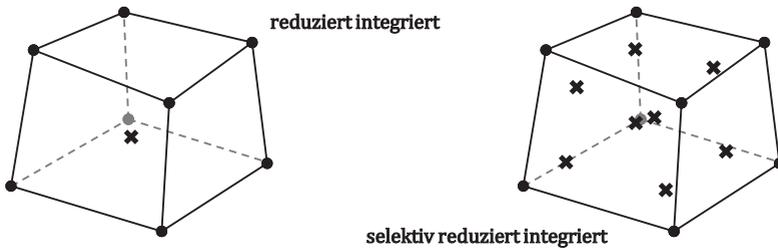
**Abb. 6-10: Integrationspunkte für reduziert integrierte und selektiv reduziert integrierte Elemente, in Anlehnung an [Er11]**
