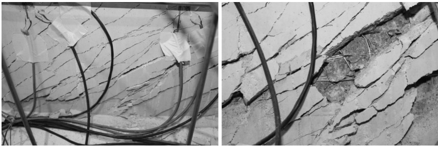
Bild 5-10: Versagensmodus des Versuchskörpers Q3
