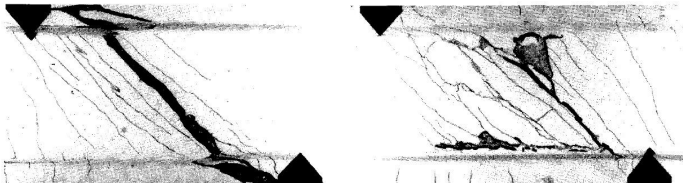
Bild 4-5: Stegzug- (links) und Stegdruckversagen (rechts) nach [Man-1991]
