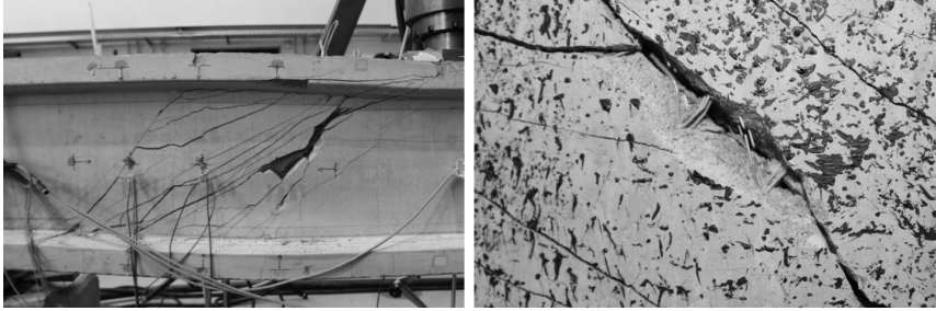
Bild 5-9: Versagensmodus des Versuchskörpers Q1
