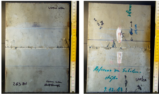
Bild F.1 Bruchbilder stumpfer Stoß
