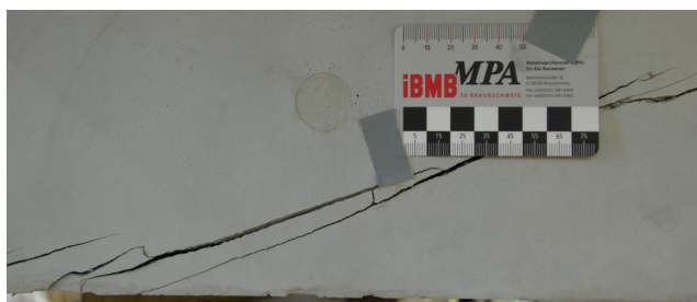
Bild 4.32 Versagen der Wandung im Steg ohne Fasern
