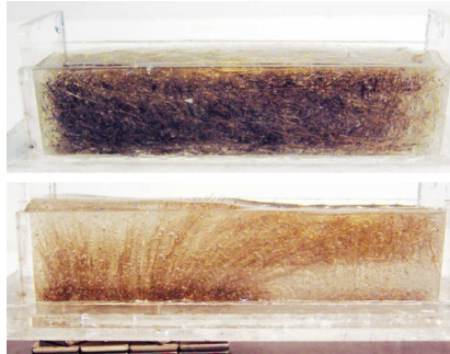
Bild 3.18 Beeinflussung der Faserorientierung \eta_\theta mit einem Magnet. Sichtbar gemacht mit Gel und Mikrodrahtfasern [Led14]
