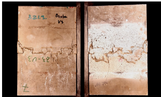
Bild F.5 Bruchbilder von Stoßtyp B3
