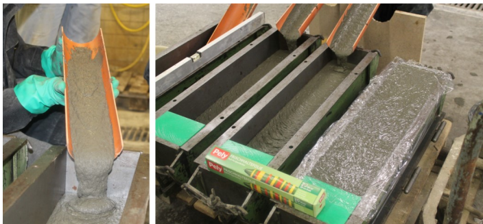
Bild 2.6 Befüllen der Probekörper von einer Seite und anschließendes Abdecken mit Folie (rechts)
