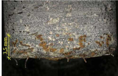
Bild 2.44 Bohrkern von einem 580 Tage in NaCl-Lösung gelagerten Prisma aufgenommen mit dem Digitalmikroskop
