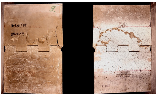
Bild F.3 Bruchbilder von Stoßtyp B1
