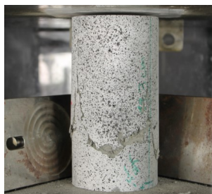
Bild 4.9 Versuchsaufbau für Rohre mit integrierter Lastumlenkung und aufgesprühtem Muster für die optische Verformungsmessung ( d / h = 100 / 173 \text{ mm} )
