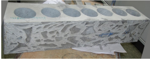
Bild 3.25 Kernbohrungen aus der Seite eines Biegebalkens für quer zur Herstellungsrichtung orientierte Druckzylinderproben
