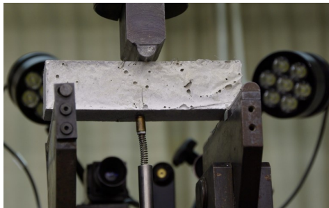
Bild 2.26 Aufbau der Drei-Punkt-Biegezugversuche an Prismen
