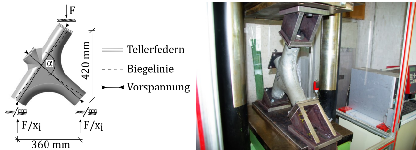
Bild 4.14 Versuchsaufbau für die Prüfung der Stabwerksknoten
