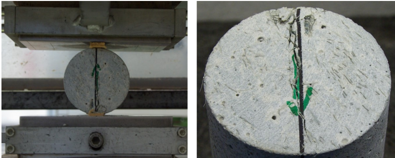
Bild 2.20 Bestimmung der Spaltzugfestigkeit (links), Rissbild nach dem Versagen (rechts)
