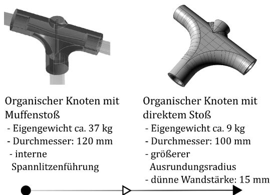
Bild 4.6 Entwicklungsschritte für einen leichten, dünnwandigen Stabwerksknoten zur Übertragung der Stabkräfte [Mai13]
