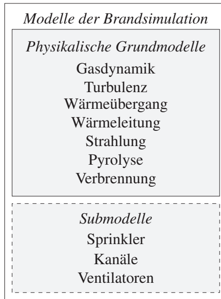
Abb. 1.2: Übersicht über die einzelnen Komponenten eines Brandsimulationsmodells
