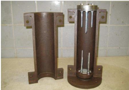
Abb. 4.3: Probekörperform für Zugproben
