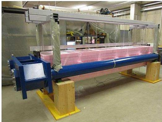
Abb. 5.24: Versuchsaufbau der TU Graz zur experimentellen Untersuchung von Zwangsspannungen infolge Hydratationswärme [Sch14]
