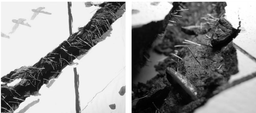
**Bild 5-24: Faserauszug und Zugversagen der Bewehrung beim Versuchskörper V3 (links) und V0 (rechts)**
