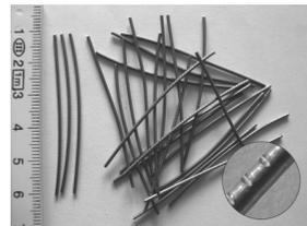
**Gerade Drahtfaser mit profilierter Oberfläche**
