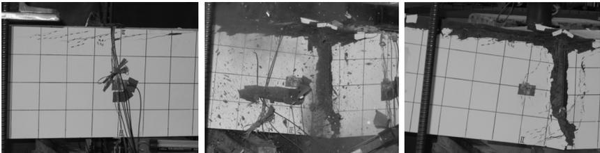
**Bild 5-33:** Explosionsartiges Versagen des Versuchskörpers V9
