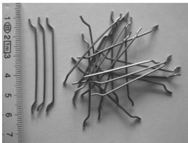
**Gerade Drahtfaser mit gekröpften Endhaken und glatter Oberfläche**
