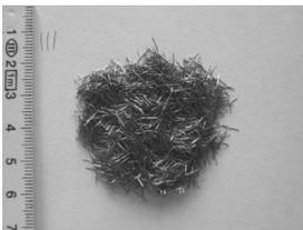
**Gerade Mikrodrahtfaser mit glatter Oberfläche**
