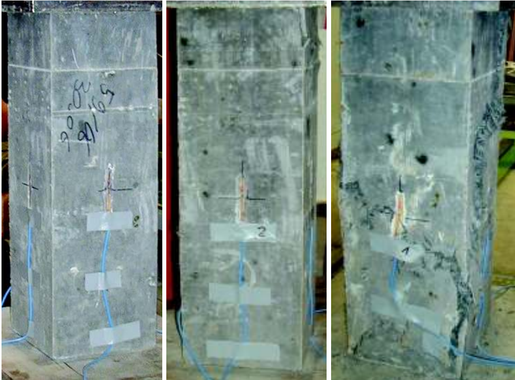
Bild E-8: UHPFRC-Stütze S3 vor dem Versuch (links), bei Erreichen der Höchstlast bei Stauchungen von 3,0 ‰ ( \Delta l_z = 1,98 mm, Mitte) und bei Versuchsende bei \varepsilon = 22 ‰ ( \Delta l_z = 14,3 mm, rechts)
