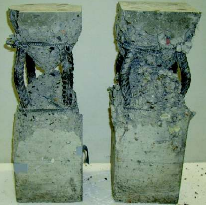
Bild F-5: Stütze VK5 (links) und VK6 (rechts) nach dem Versuch
