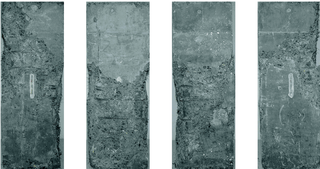
Bild E-19: UHPFRC-Stütze VK2 nach dem Versuch
