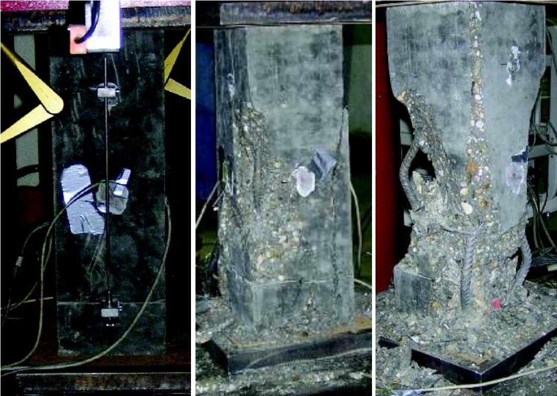
Bild F-7: Stütze VK7 vor Versuchsbeginn (links), nach Überschreiten der Höchstlast bei 1,6 ‰ (Mitte) und beim Abbruch des Versuches bei \epsilon = 12,8 \text{ ‰} (rechts)
