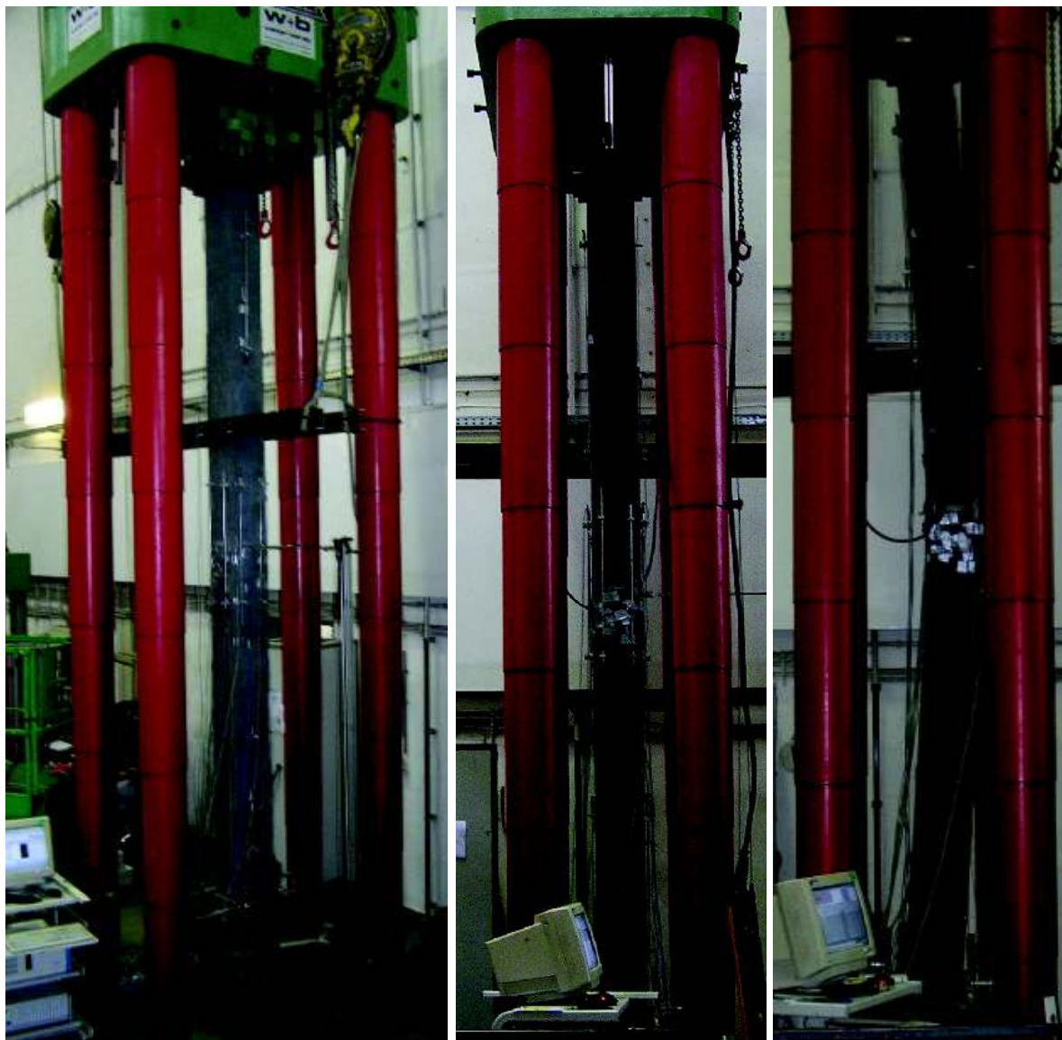
Bild H-8: UHPFRC-Stütze C1 im Versuch
