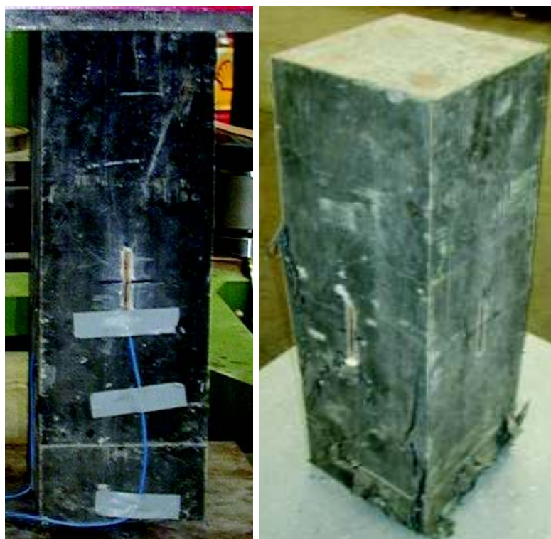
Bild E-3: UHPFRC-Stütze S1 vor Versuchsbeginn (links) und rechts nach dem Abbruch des Versuches bei \Delta l_z = 14 mm
