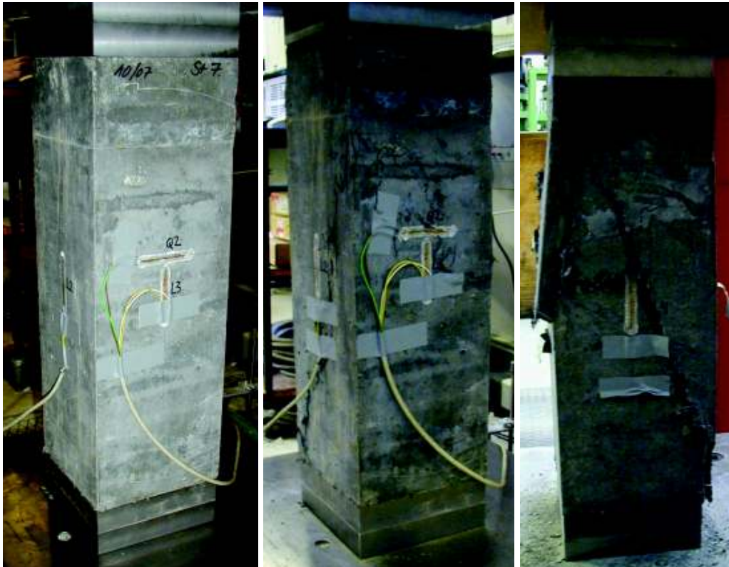
Bild E-16: UHPFRC-Stütze VK1 vor Versuchsbeginn (links), etwa bei \varepsilon = 5\text{‰} (Mitte) und beim Abbruch des Versuches bei \varepsilon = 24\text{‰} ( \Delta l_z = 15,3\text{ mm} , rechts)
