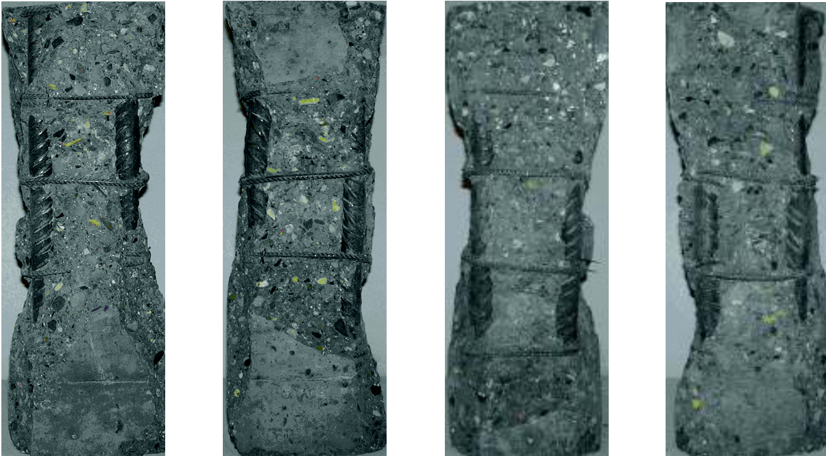
Bild F-2: Stütze VK3 nach dem Versuch
