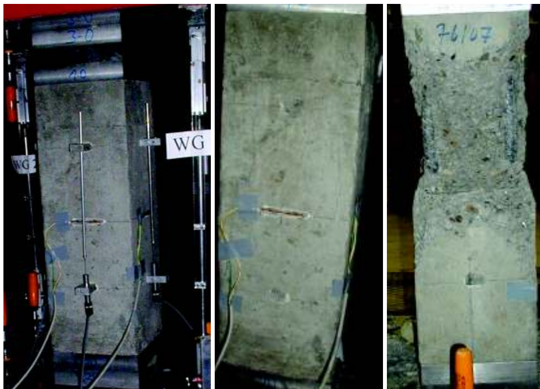
Bild F-4: Stütze VK5 vor Versuchsbeginn (links), bei Höchstlast bei 1,6 ‰ (Mitte) und bei Stauchungen von \varepsilon = 5,9 \text{ ‰} ( \Delta l_z = 3,8 \text{ mm} , rechts)
