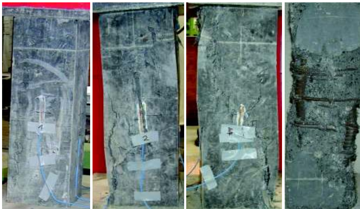
Bild E-6: UHPFRC-Stütze S2 vor Versuchsbeginn (links), bei etwa \varepsilon = 5\text{‰} (2. v.li.), beim Abbruch des Versuches bei \varepsilon = 27\text{‰} ( \Delta l_z = 17,3\text{ mm} , 3. v.li.) und rechts nach dem Abstemmen loser Betonteile
