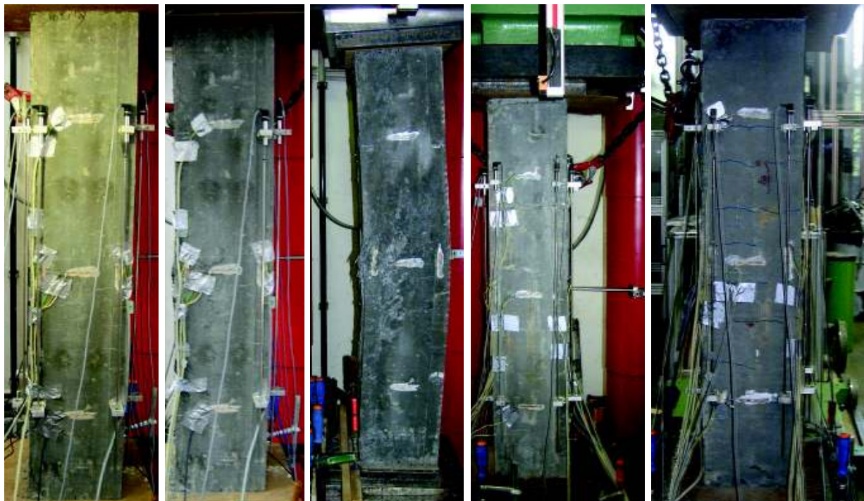
Bild G-21: UHPFRC-Stütze SE3 (1. bis 3. Bild) und SE4 (4. und 5. Bild) im Versuch
