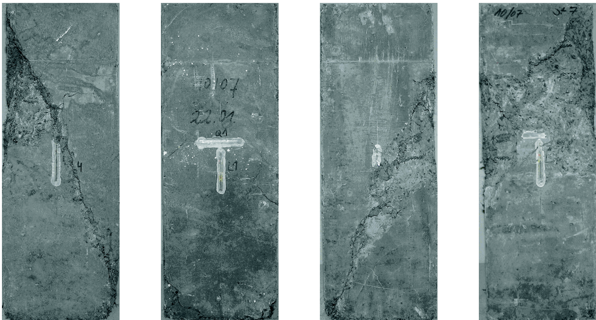
Bild E-17: UHPFRC-Stütze VK1 nach dem Versuch
