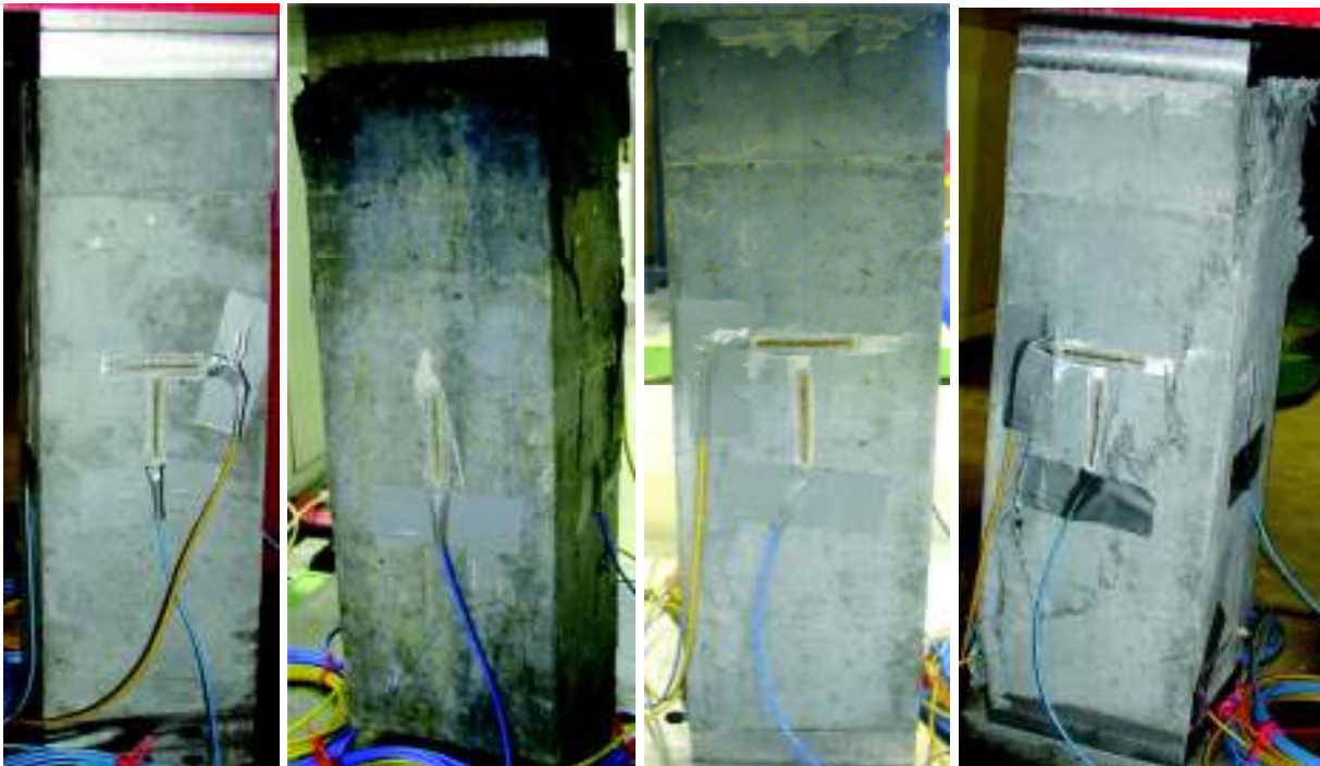
Bild E-11: UHPFRC-Stütze S4 vor dem Versuch (links) und bei Versuchsende (2.v.li.), Längsrisse bei S5 bei Erreichen der Höchstlast (3.v.li.) und S5 bei Abbruch des Versuches (rechts)
