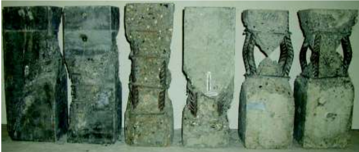
Bild 3-15: Schadensbilder der Stützen VK1 bis VK6 (von links nach rechts) nach dem Versuch
