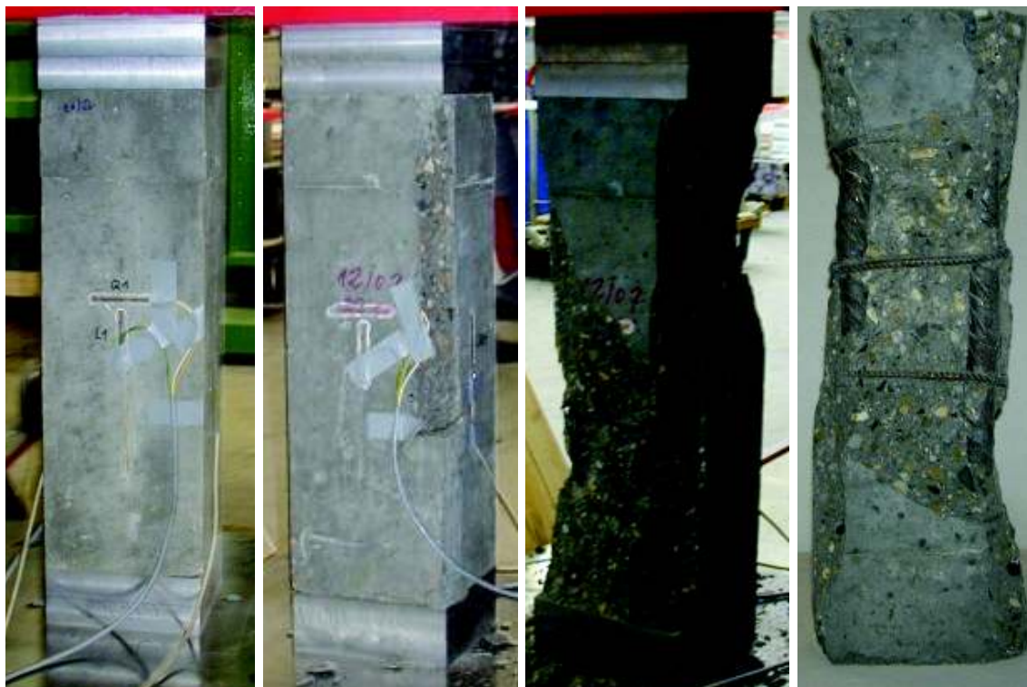
Bild F-1: Stütze VK3 vor Versuchsbeginn (links), bei Höchstlast bei 3,0‰ (2. v. li.), beim Abbruch des Versuches bei \varepsilon = 15,7\text{‰} ( \Delta l_z = 10,1 mm, 3. v. li.) und nach dem Abstemmen loser Schollen nach dem Versuch (rechts)
