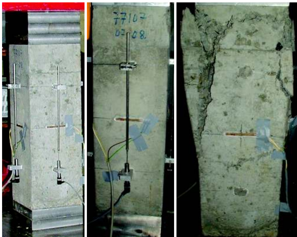
Bild F-6: Stütze VK6 vor Versuchsbeginn (links), bei Höchstlast bei 1,6 ‰ (Mitte), und beim Abbruch des Versuches bei 8 ‰ ( \Delta l_z = 5,4 mm, rechts)
