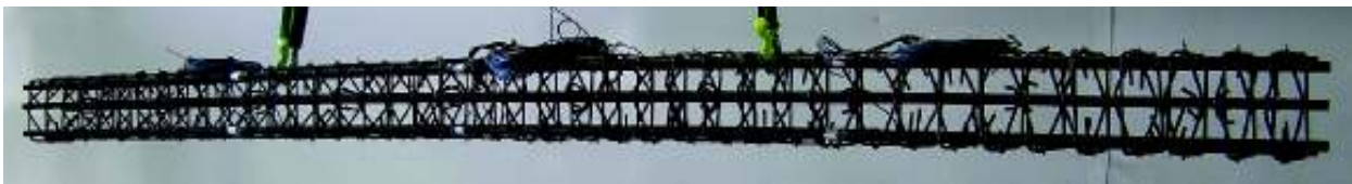
Bild H-3: Bewehrungskorb mit DMS der UHPFRC-Stütze C1
