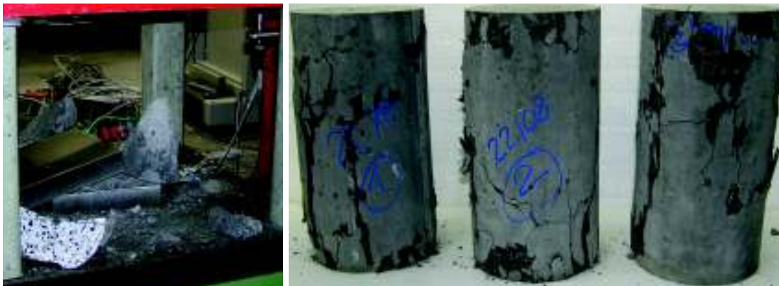
Bild 3-4: Zylinder aus UHPC 140 (links) und aus UHPFRC150 (B5Q-1, rechts) nach dem Versuch
