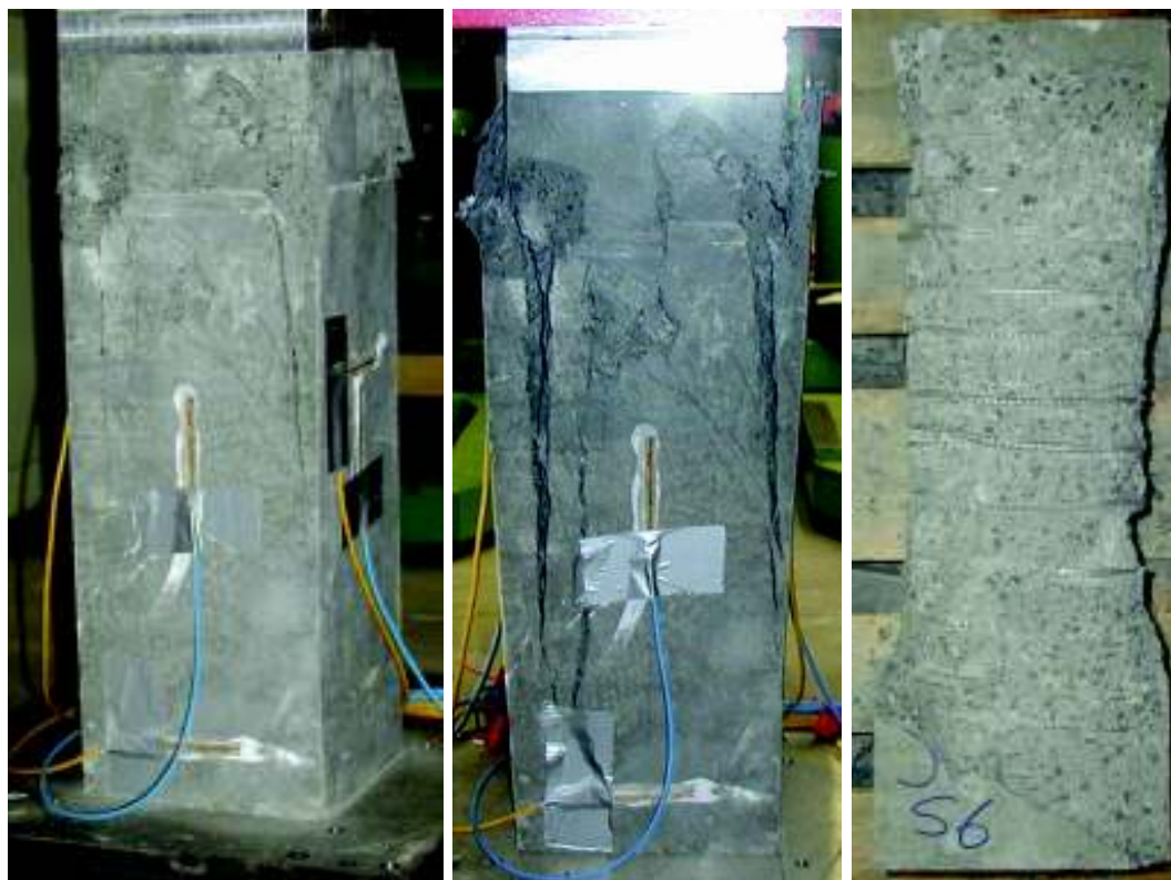
Bild E-14: UHPC-Stütze S6 bei Längsstauchungen von 4,0 ‰ (links), beim Versuchsende bei 22 ‰ ( \Delta L_z = 14,6 mm, Mitte) und nach dem Versuch (rechts)
