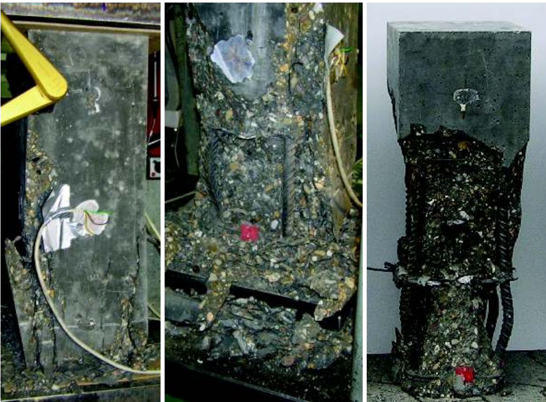
Bild F-8: Stütze VK8: Nach Überschreiten der Höchstlast bei 2,2 ‰ (links), beim einsetzenden Ausknicken der Längsbewehrung bei 2,5 ‰ und nach dem Versuch (rechts)
