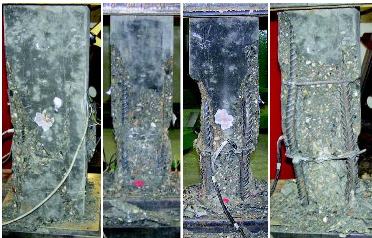
Bild F-9: Stütze VK9: Kurz nach Überschreiten der Höchstlast (2,0 ‰) bei 2,2 ‰ (links), beim einsetzenden Ausknicken der Längsbewehrung bei 3,5 ‰ (2. und 3. von links) und bei Versuchsabbruch bei 7 ‰ (rechts)
