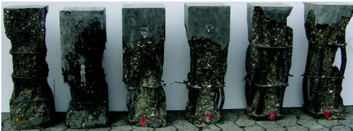
Bild 3-16: Schadensbilder der HPC- und HPFRC-Stützen nach dem Versuch (von links nach rechts: VK3, VK4 und VK7 bis VK10)
