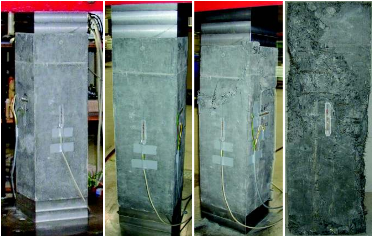
Bild E-18: UHPFRC-Stütze VK2 vor Versuchsbeginn (links), bei Höchstlast bei 3,1 ‰ (2. v. li.), beim Abbruch des Versuches bei \epsilon = 22,6 \text{ ‰} ( \Delta l_z = 14,5 \text{ mm} , 3. v. li.) und nach dem Versuch (rechts)
