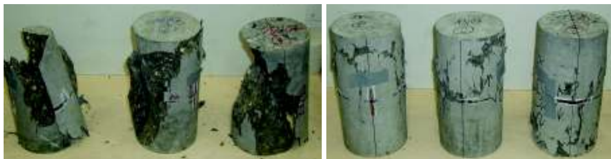
Bild B-7: Probekörper aus C80/95 (VK3, links) und FRC70/85 (VK4, rechts)
