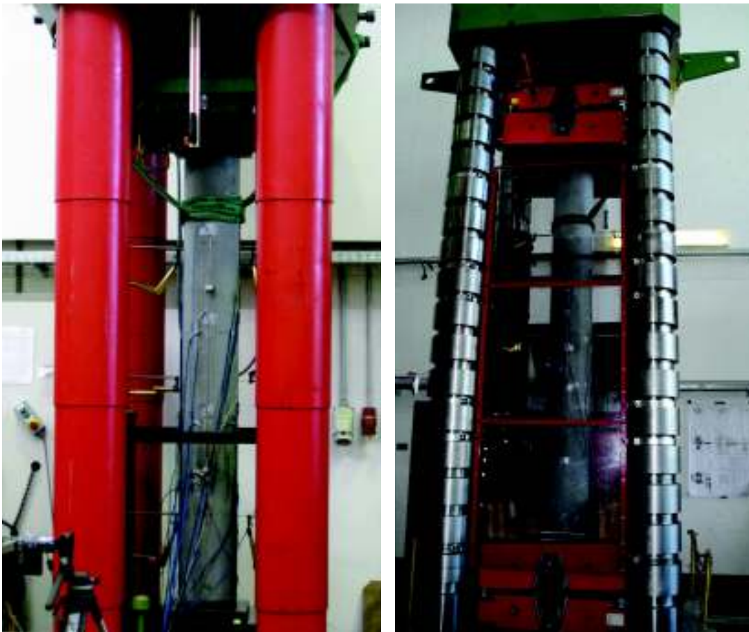
Bild 2-24: Versuchsaufbau der UHPC-Schleuderbetonstützen in der 10 MN- (links) und 30 MN-Prüfmaschine [46]
