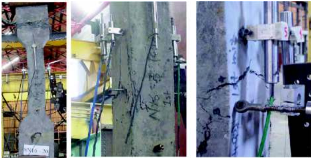
Bild 2-31: Stütze RPC1 im Versuch (links) sowie nach dem Bruch auf der Druckseite (Mitte) und Zugseite (rechts) [43]
