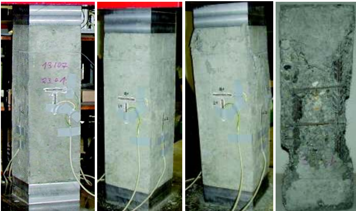
Bild F-3: Stütze VK4 vor Versuchsbeginn (links), bei Höchstlast bei 3,5 ‰ (2. v. li.), beim Abbruch des Versuches bei \epsilon = 21,6 \text{ ‰} ( \Delta l_z = 13,9 \text{ mm} , 3. v. li.) und nach dem Abstemmen loser Schollen nach dem Versuch (rechts)
