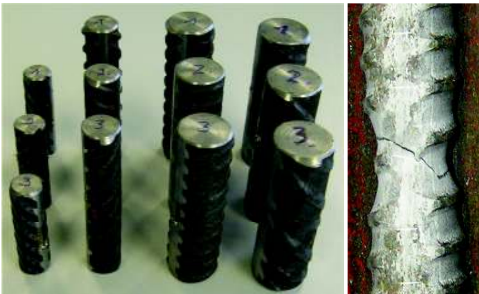
Bild D-5: Druckproben (links) und Zugprobe (rechts) nach dem Versuch
