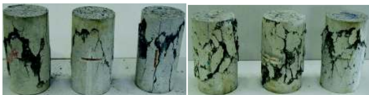
Bild B-8: Probekörper aus C25/30 (VK5, links) und FRC30/37 (VK6, rechts)
