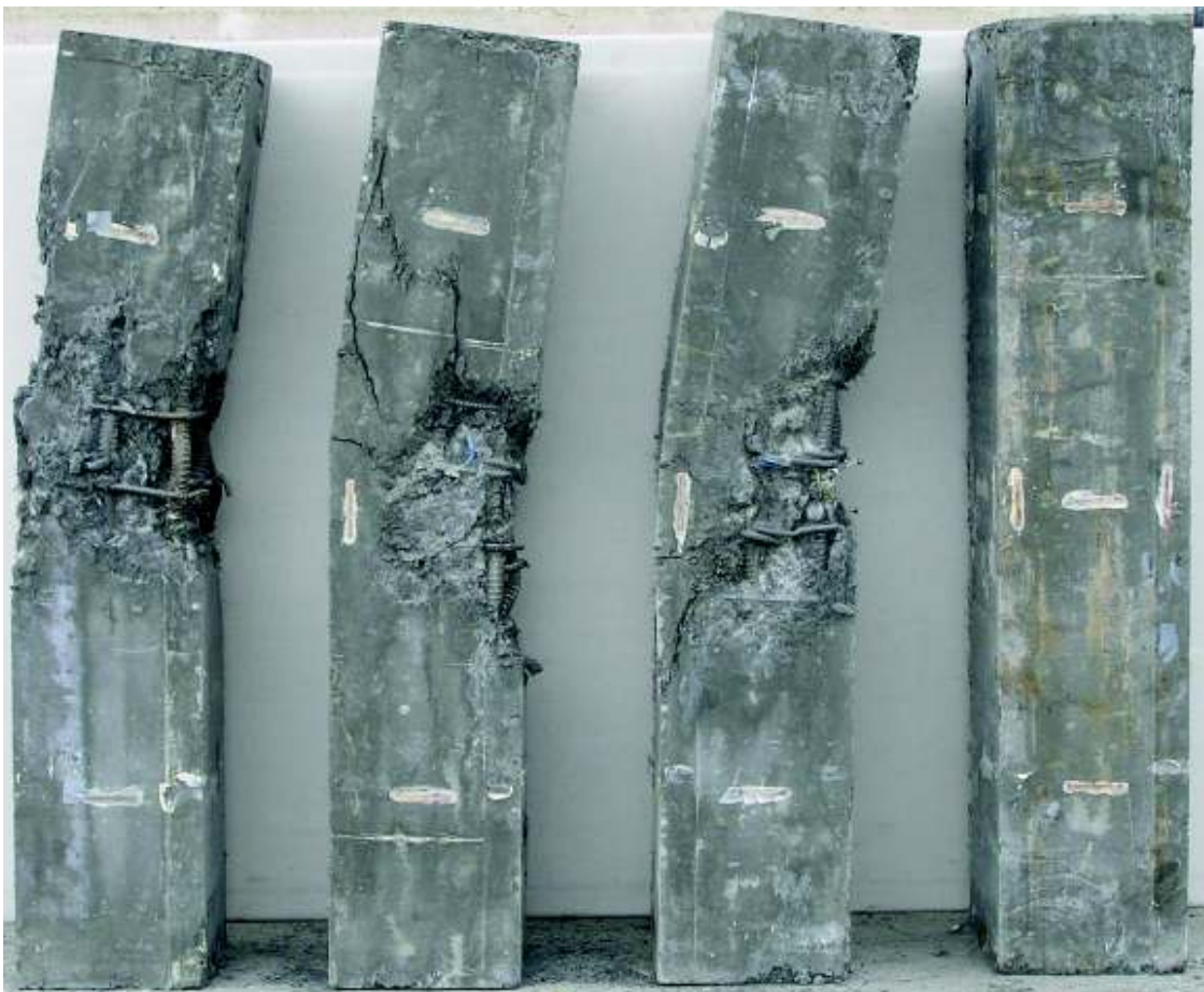
Bild G-23: UHPFRC-Stützen SE1 bis SE4 (von links nach rechts) nach dem Versuch
