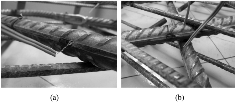
Bild B-10: DMS auf Betonstahl: (a) E6 bei x = 30 cm und (b) bei c = 0 cm
