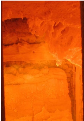
Bild 3.57 Kleinbrandversuch (1): Beschichtung auf Wandbauteil B; 43. Brandminute [INO09]
