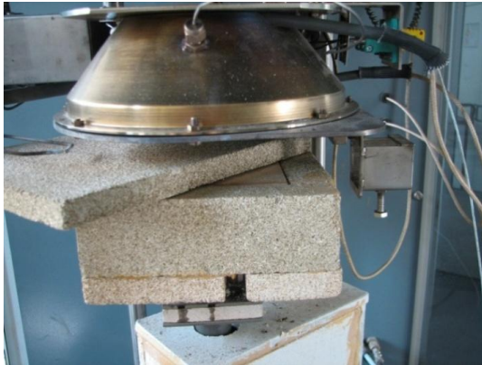
Bild 3.12 Überprüfung der Auswirkung von Vorwärmung auf die Zündtemperatur bei abgedeckten Holzproben [INO09]
