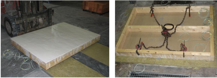
Bild 3.55 Deckenbauteil für Kleinbrandversuch 1: links: zu beflammbende Seite; rechts: Rückseite [INO09]
