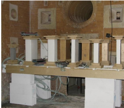
Bild 3.34 Brandversuch im Wandbrandhaus, Anordnung der Probekörper [INO09]
