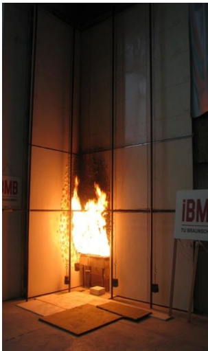
Bild 3.28 Beflammung der Versuchsfassade mit Blickrichtung aus zwei Perspektiven
