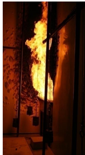
Bild 3.28 Beflammung der Versuchsfassade mit Blickrichtung aus zwei Perspektiven
