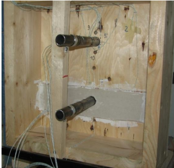
Bild 3.46 Untersuchung Konstruktionsdetails: Probekörper mit Rohrdurchführung; links: Innenansicht vor dem Ausstopfen mit Steinwolle, rechts: Ansicht vom Brandraum aus [INO09]
