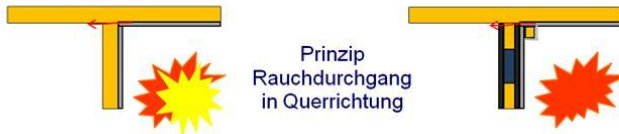
Bild 3.65 Kleinbrandversuch (3): Anordnung der Rauchkästen und Prinzip der Messung [INO09]
