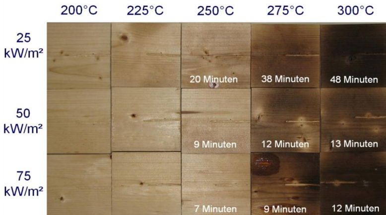
Bild 3.13 Beobachtungen der Versuche zur Auswirkung der Vorwärmung auf die Zündtemperatur mit abgedeckten Proben [INO09]
