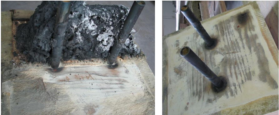
Bild 3.48 Untersuchung Konstruktionsdetails: Probekörper mit Rohrdurchführung; Außenseite nach dem Brandversuch [INO09]
