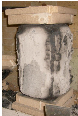
Bild 3.37 Kleinbrandversuch im Wandbrandhaus: Probekörper 8 während und nach der Beflammung [INO09]
