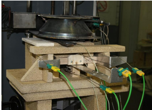
Bild 3.15 Untersuchungen zum Entzündungsverhalten von Fichtenholz mit gedämmter Oberfläche und Temperaturmessungen über die Tiefe
