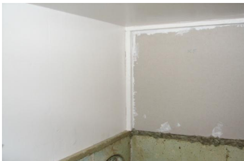
Bild 3.64 Kleinbrandversuch (3): Ecksituation mit Eckleisten [INO09]
