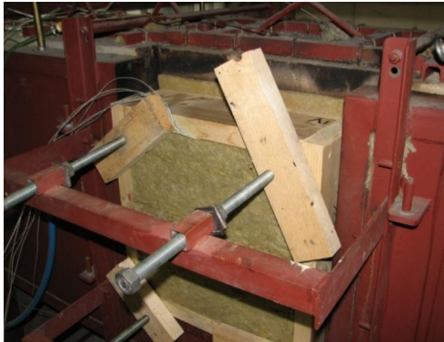
Bild 3.39 Untersuchung Konstruktionsdetails: Gefachbereich Holztafelelement nach Einbau in den Kleinbrandofen nach DIN 4102-8 [INO09]
