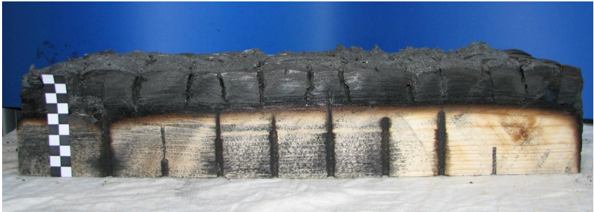
Bild 3.32 Probekörper nach Beflammung im Kleinbrandofen nach DIN 4102-8; die schwarzen Streifen markieren die Bohrungen für die Thermoelemente [INO09]
