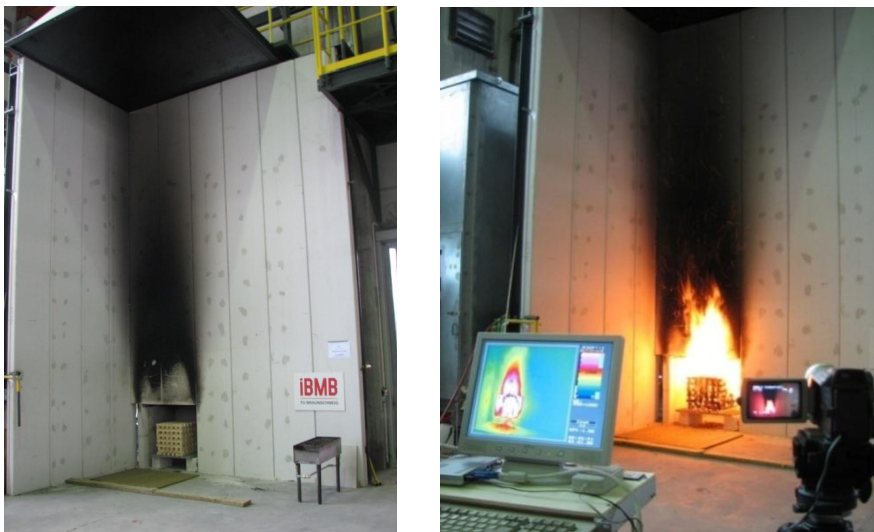
Bild 3.5 Versuchsstand des iBMB für Fassaden-Großbrandversuche; Darstellung der Kalibrierversuche vor und nach dem Entzünden der Holzkrippe; Alternativ erfolgt die Beflammung mittels Gasbrenner, im linken Bild neben dem Prüfstand stehend
