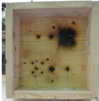
Bild 3.43 Untersuchung Konstruktionsdetails: Innenseite des Probekörpers mit metallischen Anbauteilen nach dem Versuch [INO09]
