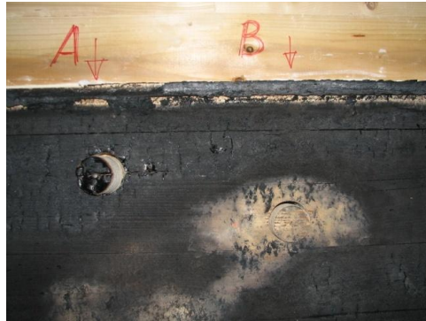
Bild 3.67 Kleinbrandversuch (3): Entnahmestellen der Bohrkern A und B mit räumlicher Nähe [INO09]
