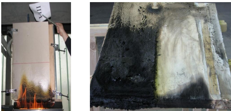
Bild 3.3 Fassaden-Laborbrandversuch; links: Versuch der Entzündung eines Blattes Papier; rechts: abgebrannter Probekörper des Lastfalls Vollast
