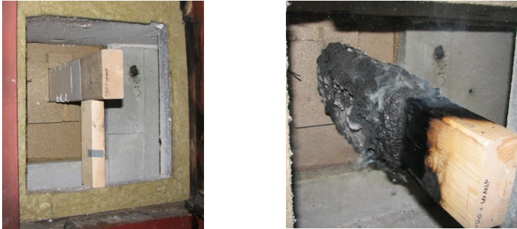
Bild 3.50 Untersuchung Konstruktionsdetails: Nagelplattenversuche; links: Einbau der Probekörper in den Kleinbrandofen nach DIN 4102-8; rechts: Probekörper nach dem Brandversuch [INO09]
