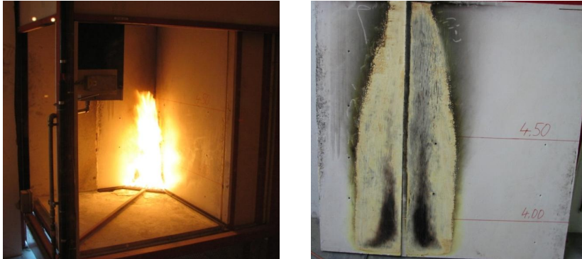
Bild 3.23 SBI-Test am Fassadensystem, links: Phase kurz nach Zündung des Brenners; rechts: Substrat mit leichten Verkohlungen und Verfärbungen nach dem Brandversuch, Beschichtungssystem RAB7-2a, kalkulierte Schichtdicke 500 \mu\text{m} [INO09]
