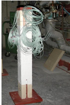
Bild 3.51 Beschichteter Probekörper mit Nagelplattenverbindung vor Einbau [INO09]
