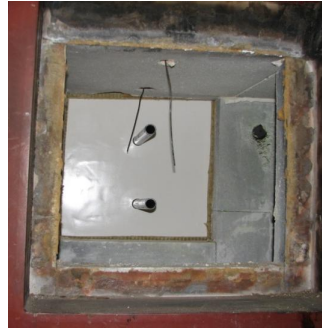
Bild 3.46 Untersuchung Konstruktionsdetails: Probekörper mit Rohrdurchführung; links: Innenansicht vor dem Ausstopfen mit Steinwolle, rechts: Ansicht vom Brandraum aus [INO09]
