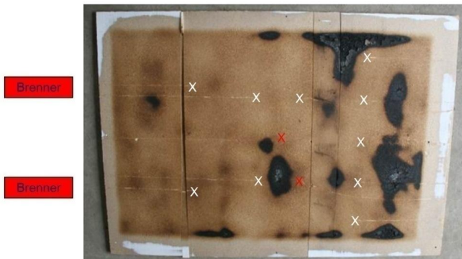
Bild 3.58 Kleinbrandversuch (1): Deckenbauteil nach Versuchsende und Entfernung der Beschichtung; Kreuze markieren Messstellen mit Thermoelementen [INO09]
