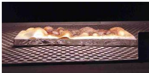
Bild 12: Unregelmäßige Oberfläche einer reagierten Brandschutzbeschichtung
