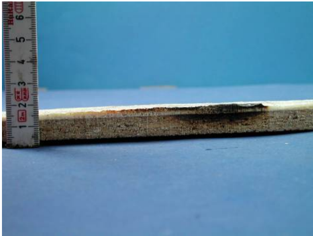
Bild 23: Ansicht einer KE-Formulierung nach Beflammung im Brandkasten nach DIN 4102
