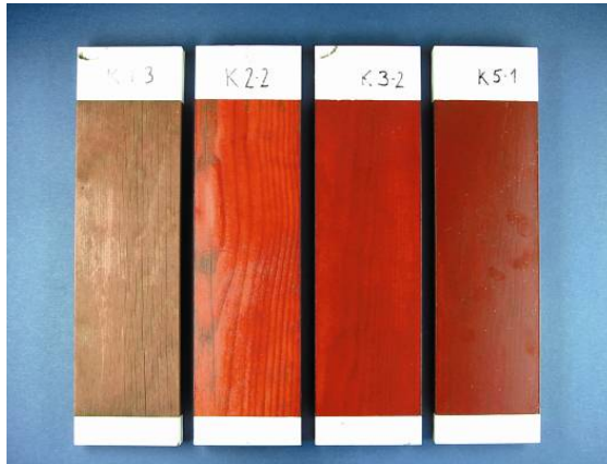
Bild 7: Anstrichsystem mit unterschiedlichen Schichtdicken nach zweijähriger Bewitterung.
