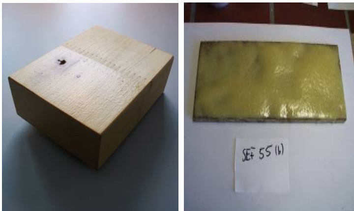
Bild 24: Vergleich der Oberflächenqualität der SEF 84 mit einem keramisierenden Elastomer
