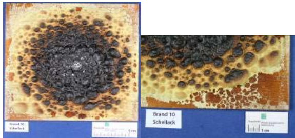
Bild 58: Brandschutzdecklack (RAB 6- S 12) auf Schellack nach Brandversuch
