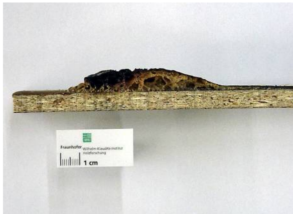
Bild 26: Probekörper mit dünner, keramisierte Schutzschicht (SEF 84)
