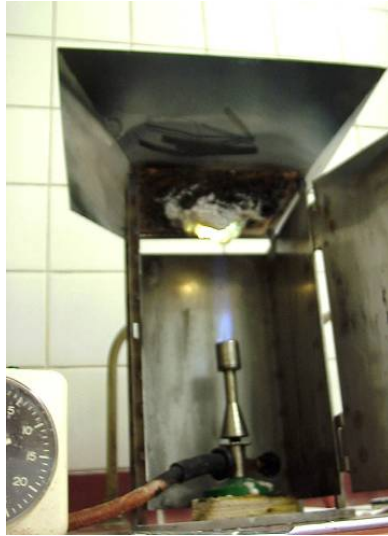
Bild 17: Laborversuchsanordnung bei geöffneter Fronttür mit Bunsenbrenner und Probekörper
