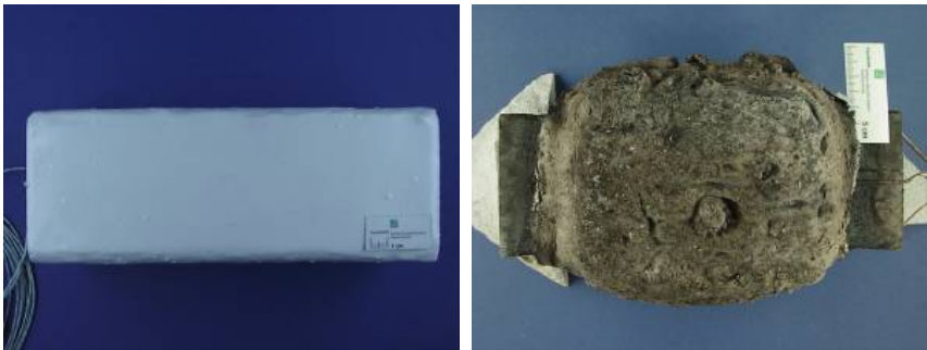
Bild 48: Probekörper S11 vor und nach Ofenbrandversuch
