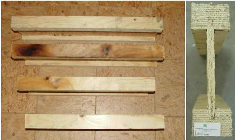
Bild 95: Ausgebaute Abschnitte des mittleren und eines äußeren I-Trägers
