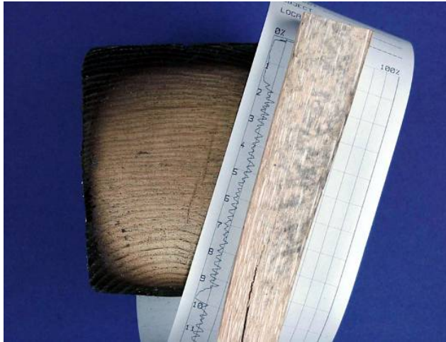
Bild 50: Ergebnis der Bohrwiderstandsmessung am Probekörper S 11
