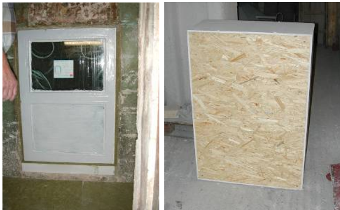
Bild 64: Wandelemente (links Holzrahmen mit Brandschutzverglasung, rechts OSB-Platte auf Ständerwerk) im Versuch 1
