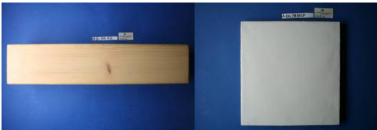
Bild 101: Probekörper nach 9-monatiger Lagerung in geschützten Bereichen
