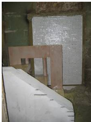
Bild 72: Anordnung der Akustikwand und der Treppe im Brandofen
