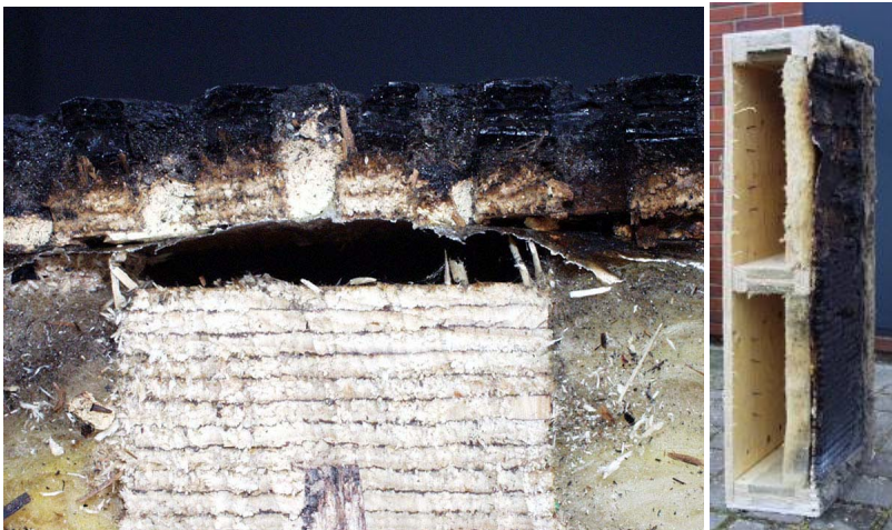
Bild 94: Schnitt durch das Bauteil und Detail mittlerer I-Träger – Lochplatte
