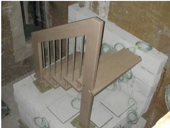
Bild 90: Treppenbauteil im Großbrandraum
