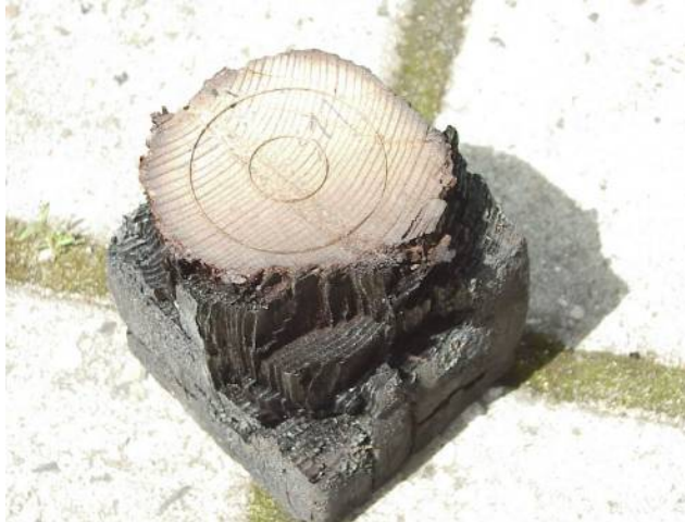
Bild 56: Stütze S 11 nach der Druckfestigkeitsprüfung
