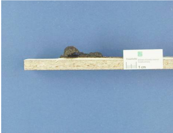
Bild 27: Probekörper IN 25 nach 30 Minuten Beflammung im Brennkasten
