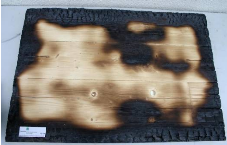
Bild 84: Oberfläche der geprüften Wand nach dem Entfernen der Schutzschicht
