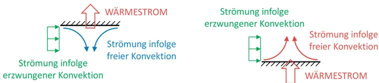
Abbildung 3.9: Quer verlaufende Strömung (*transverse flow*)
