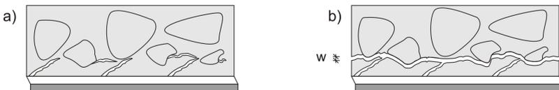
Bild 2.5: a) Ausbildung von Sekundärrissen bis zum Betondruckgurt, b) Ausbildung der Verbundbruchfläche (LEKB)
