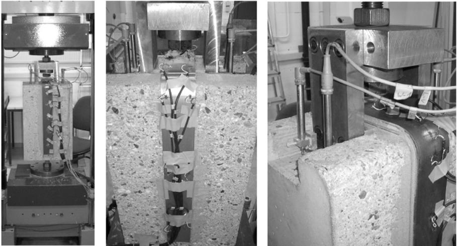
Bild 3.3: Probekörper im Versuchsstand mit abgebildeter Lasteinleitung
