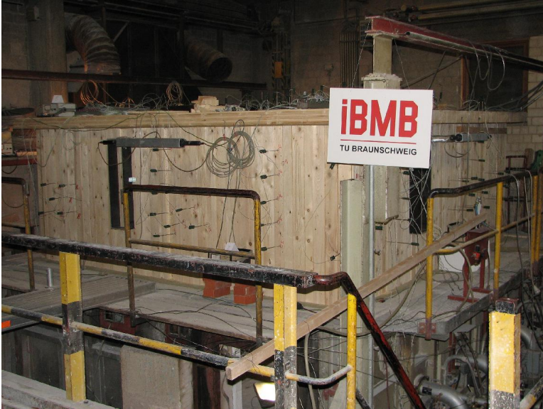
Bild 28: Versuchsaufbau des Großbrandversuchs
