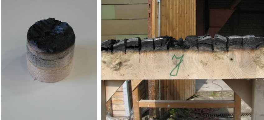
Bild 31: Bestimmung der Abbrandtiefe; links mittels Bohrkernen, rechts an Schnittkanten
