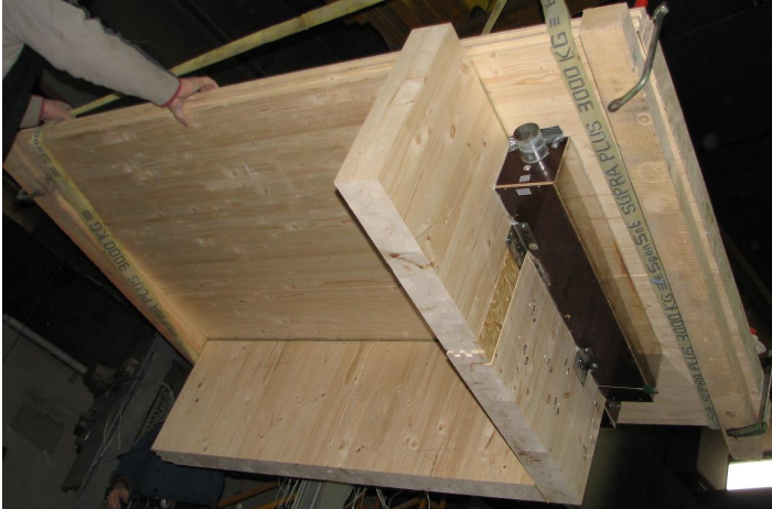
Bild 25: Probekörper für Kleinbrandversuche
