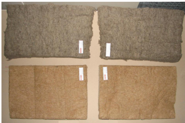
Bild 18: Dämmstoffoberflächen nach 60-minütigem Normbrand
