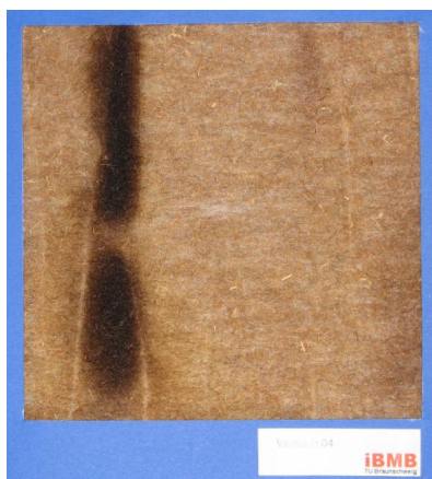
Bild 15: Thermische Zersetzung der Hanf-Matte AF im Stoßbereich der Brandschutzbekleidung
