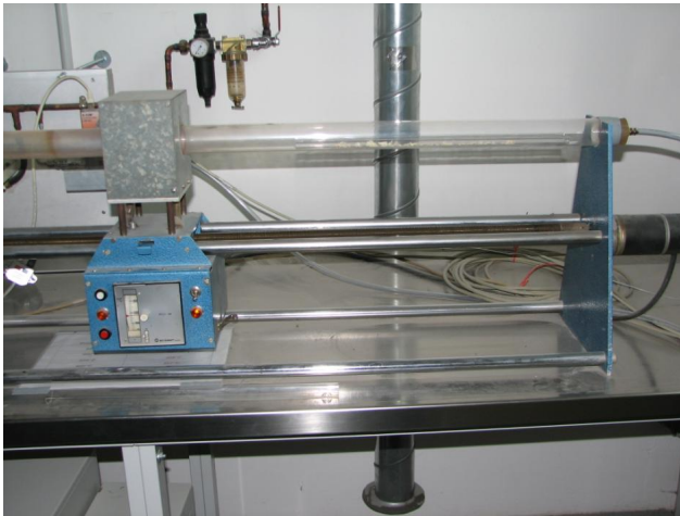
Bild 12: Prüfaufbau zur Bestimmung der Rauchgasentwicklung [10]
