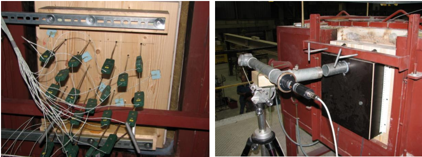
Bild 20: Versuchsaufbau der kleinformatischen Versuche im Brandofen nach DIN 4102-8 [12]
