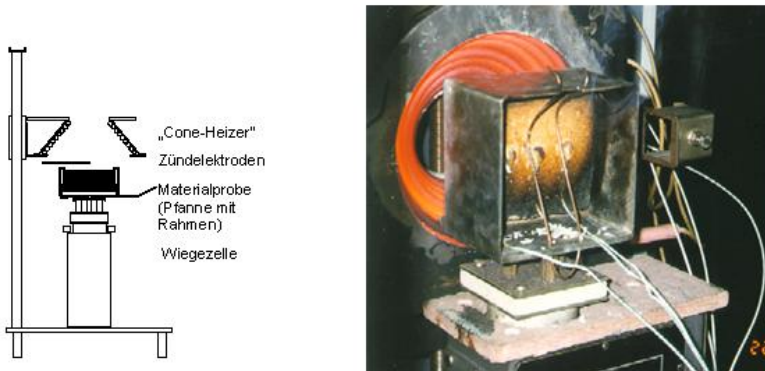
Bild 2: Versuchsaufbau im Cone-Kalorimeter [5]
