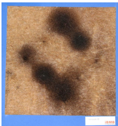
Bild 17: Thermische Zersetzung auf der Hanf-Matte AF bei durchgehenden Schrauben
