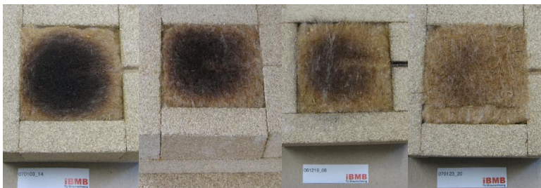
Bild 11: Dämmstoffoberfläche nach Erreichen von 275 °C, 250 °C, 225 °C und 200 °C im Cone-Kalorimeter [10]
