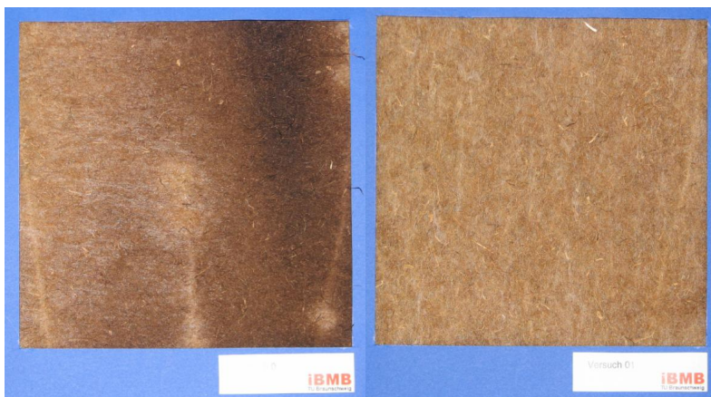
Bild 14: Oberfläche der Hanf-Matte AF nach Erreichen von 225 °C (links) und 200 °C (rechts) im Kleinbrandofen [10]
