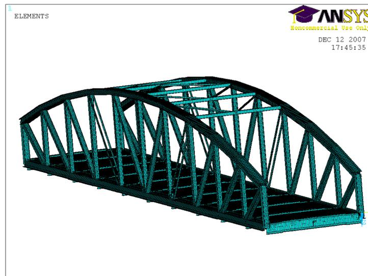
Abbildung 9.2: Verwendetes Stabwerksmodell der Fachwerkbrücke
