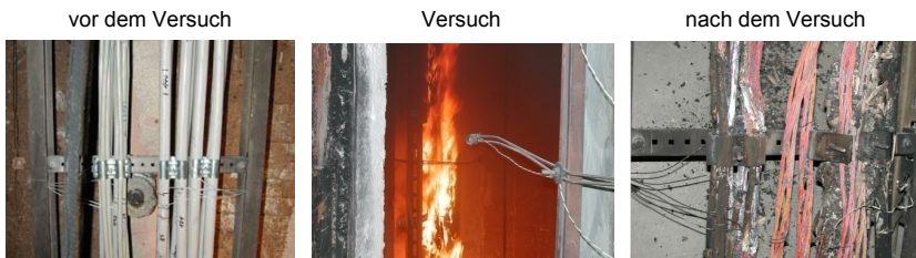
Bild 25 Kabelbelegung der Trasse mit zwei separaten Bündeln vor dem Versuch, während und nach dem Versuch
