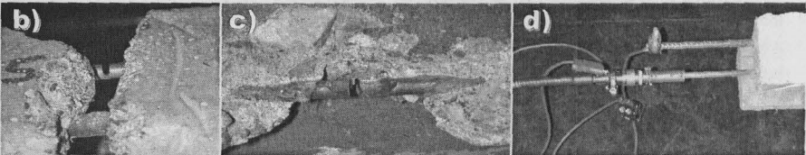
Abb. 7.51: Skin_Beton -Versuche: a): Unmaßstäbliche Skizze von Grundriss und Querschnitt des Versuchskörpers auf dem U 100-Schalprofil, b): Kerbstelle des Stabes 1 (hinten) mit Massestab 2 beim Versuch Skin_Beton_6 , c): Kombination von Fremdstromkorrosionsabtrag und mittels Trennschleifer generierter Bruch beim Versuch Skin_Beton_4 und d): Photo der HF-Endankopplung mit Messingbuchse sowie Masseverbindungskabel mit Schalter
