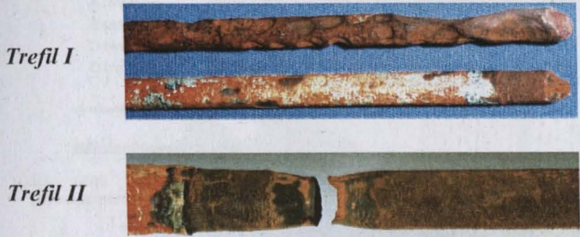
Anhang A5: Korrodierte Spannstähle des Typs TrefilArbed ( d_0 = 7 mm) des Versuches Trefil I (Soll-Korrosionslänge l_{Korr} = 1 cm) und Trefil II ( l_{Korr} = 10 cm) nach Versuchsende
