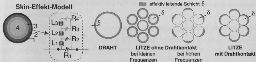
Abb. 6.4: Elektrisches Modell: Ersatzschaltkreis zum Skineffekt (paralleler R-L-Stromkreis „Leiter“), [208]
