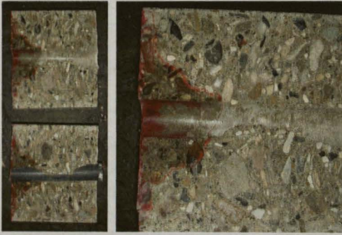
Abb. A-3: Wassereindringfront/Farbverteilung in einem Versuchskörper mit Kunststoffzylinder.
