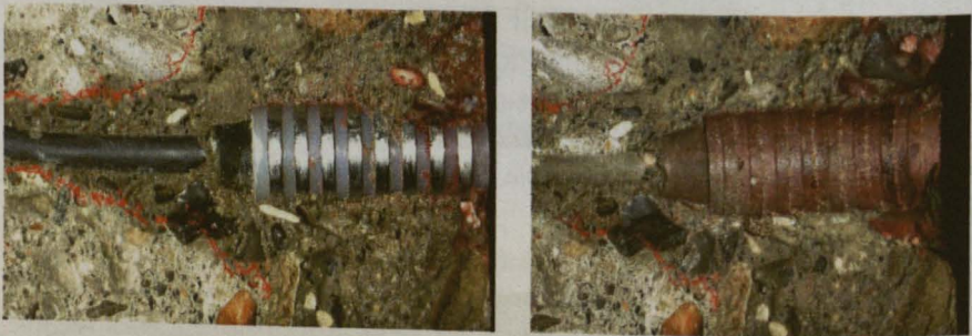
Abb. 3-7: Wassereindringprofil und Farbverteilung im Bereich der MRE nach Druckwasserbeaufschlagung analog der DIN EN 12390-8 [58].
