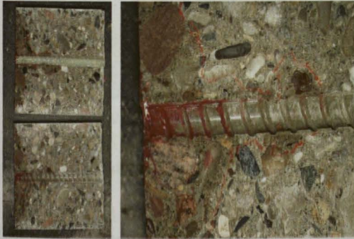
Abb. A-1: Wassereindringfront/Farbverteilung in einem Versuchskörper mit glasfaserverstärktem Kunststoff-Bewehrungsstab.
