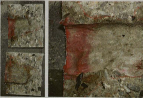
Abb. A-4: Wassereindringfront/Farbverteilung in einem Versuchskörper mit Feldstein aus Quarzgestein.
