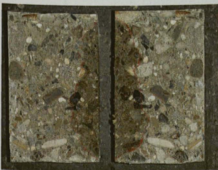
Abb. A-10: Wassereindringfront/Farbverteilung bei einer nicht präparierter Wasserplatte (Vergleichskörper)
