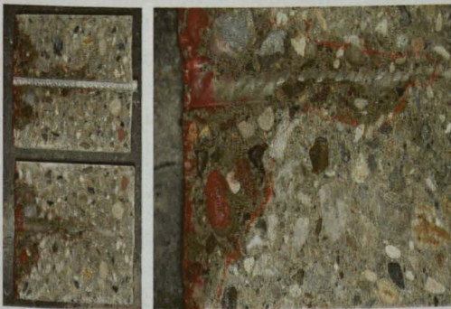
Abb. A-2: Wassereindringfront/Farbverteilung in einem Versuchskörper mit Bewehrungsstab aus Edelstahl A4/Bst 500 NR.
