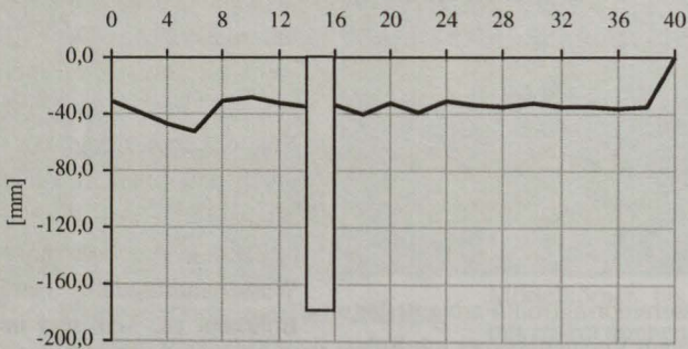
Abb. A-11: Wassereindringtiefe nach Bohrhammerbohrung an 54 Tage alter Prüfplatten mit einer 28 Tage-Festigkeit von 44 \text{ N/mm}^2 .
