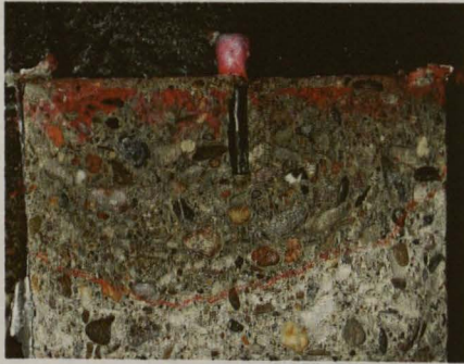
Abb. 4-19: Wassereindringtiefe und Farbgrenze des huckepack transportierten Eosins nach Wasserbeaufschlagung unter 0,50 MPa beim VK_055-7.
