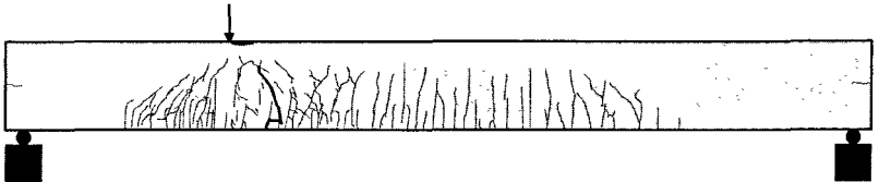
Bild 12.94: Rissbild Balken G06 nach dem anschließenden Schubversuch
