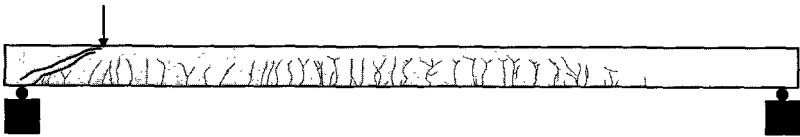
Bild 12.89: Rissbild Balken G03 nach dem anschließenden Schubversuch
