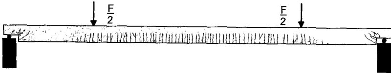
Bild 12.87: Rissbild Balken G02
