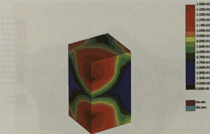
Bild 5.2.6.14 Hauptdruckspannungen von 0 bis -150 MPa beim Versagen (Stützenlast 3000 kN). Stütze ohne seitliche Platte ohne Panzerung, unverformt
