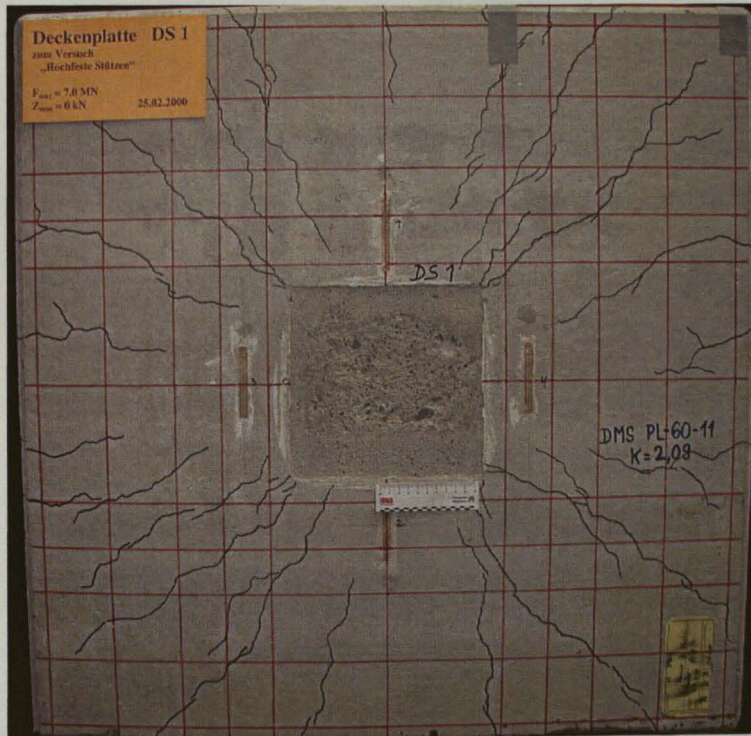
Bild 4.1.5 Rißbild nach Belastung mit P_u = 7000 kN, Versuchskörper DS1
