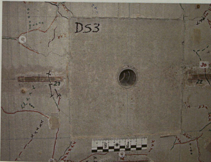
Bild 4.3.6 Sichtbare bleibende Stauchung im Lasteinleitungsbereich Versuchskörper DS3
