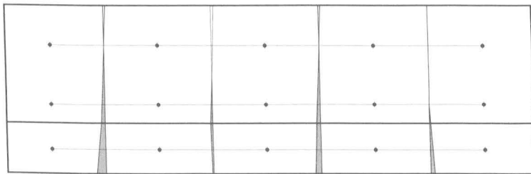
Bild C 49: Horizontale Dehnungsverteilung vor der ersten Rissbildung ( M=0,39\text{ MNm} )
