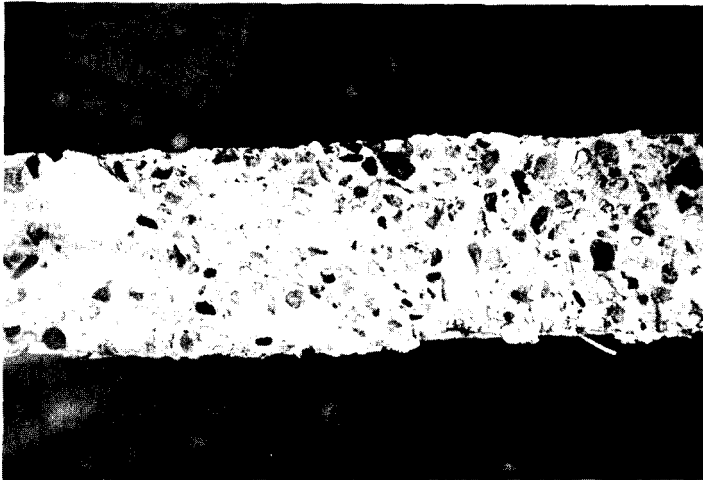
Bild 5.4: Aufsicht auf die Bruchfläche der Lasche nach vorgängiger dynamischer Belastung
