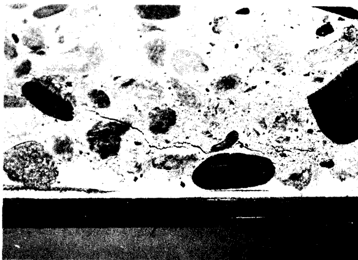
Bild 5.19: Verbundrisse nach erstmaliger Belastung
