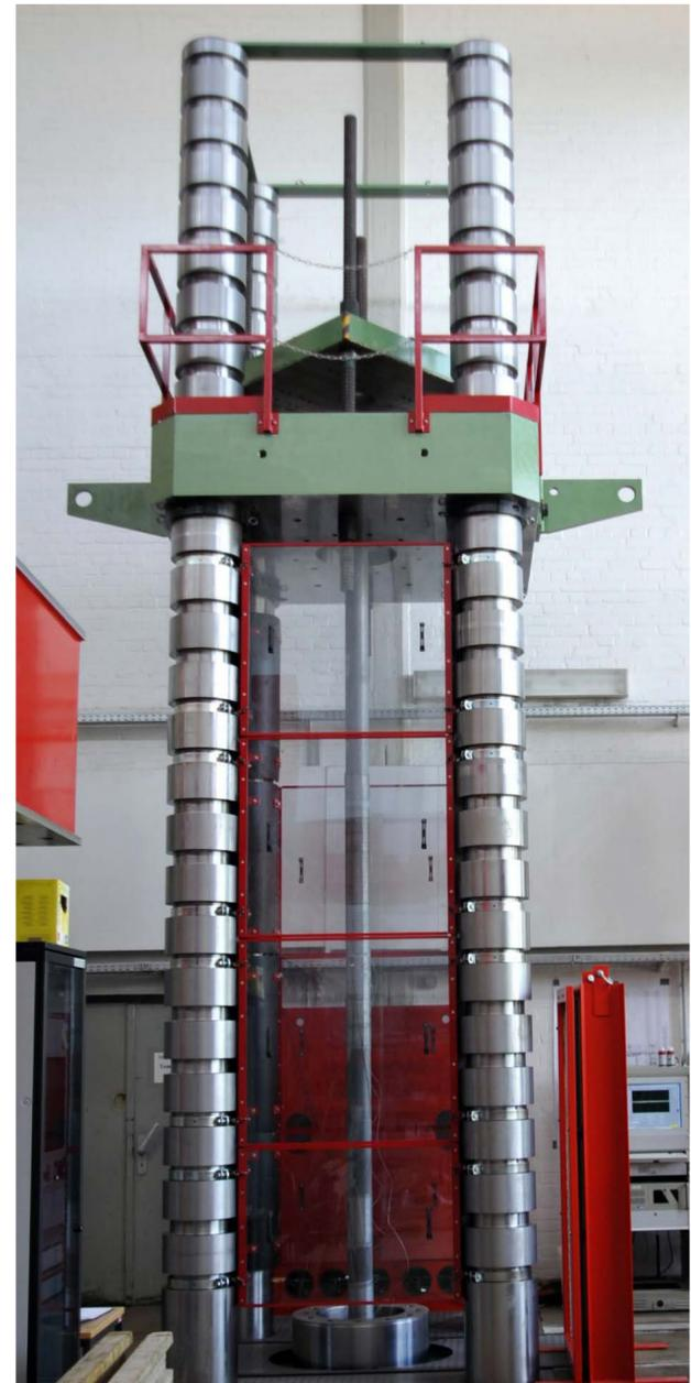
30-MN-Prüfmaschine im Zugversuch
