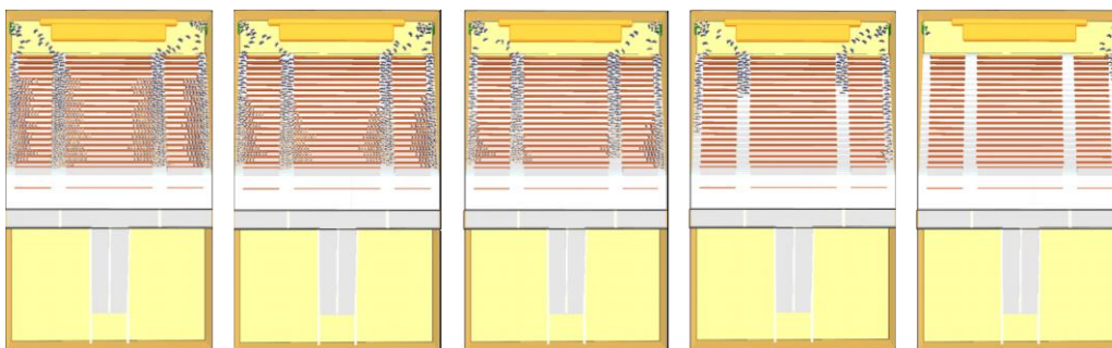
Bild A2.43 FDS+Evac - Positionen der Personen nach 45, 90, 135, 180 und 225 Sekunden für den 2. Rettungsweg (S. Scheltern)
