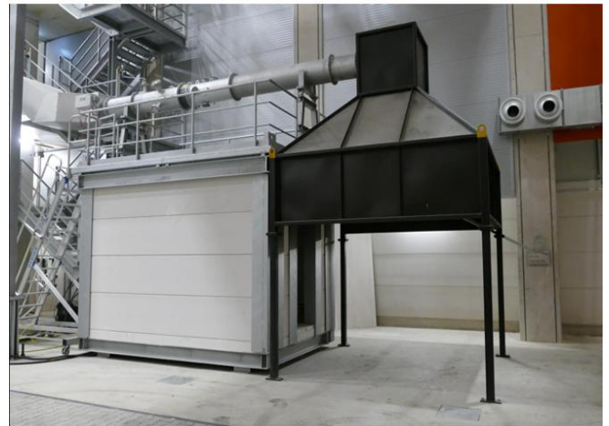
Ansicht des Room Corner Testraums, bestehend aus Testraum, Haube und Absaugrohr mit Messtechnik
