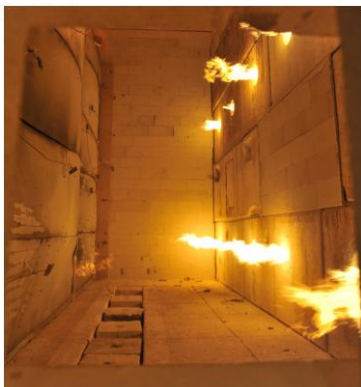
Brandversuch an einem mechanisch unbelastetem Wandaufbau aus Sandwichelementen
