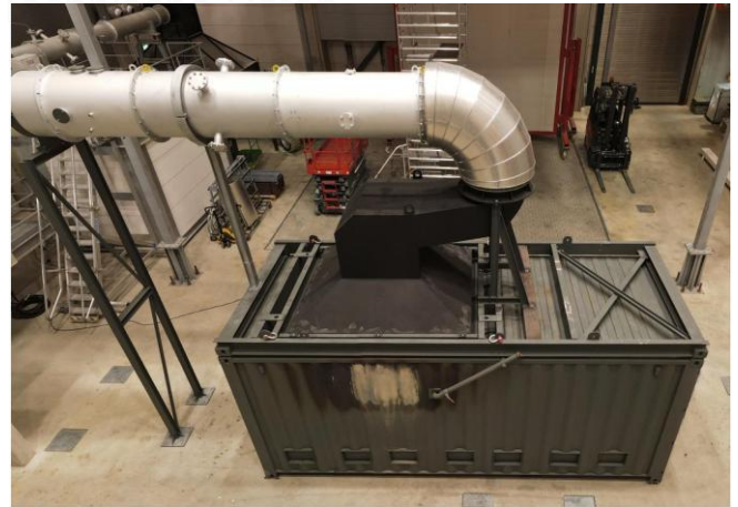
Ansicht des Containerkalorimeter K5, bestehend aus Testraum, Haube und Absaugrohr mit Messtechnik
