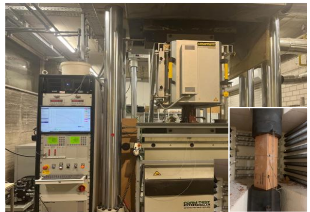
Heißdruckmaschine und eingebauter Probekörper inkl. Temperatur- und Verformungseinrichtung (rechts unten)
