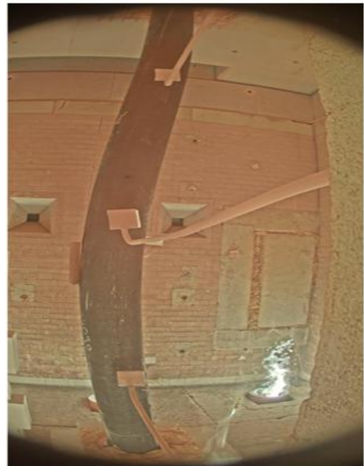
Verformungsverhalten einer Verbundstütze
