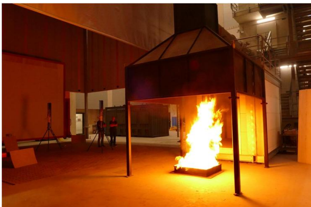
Versuch unter der Haube des Room Corner Testraums
