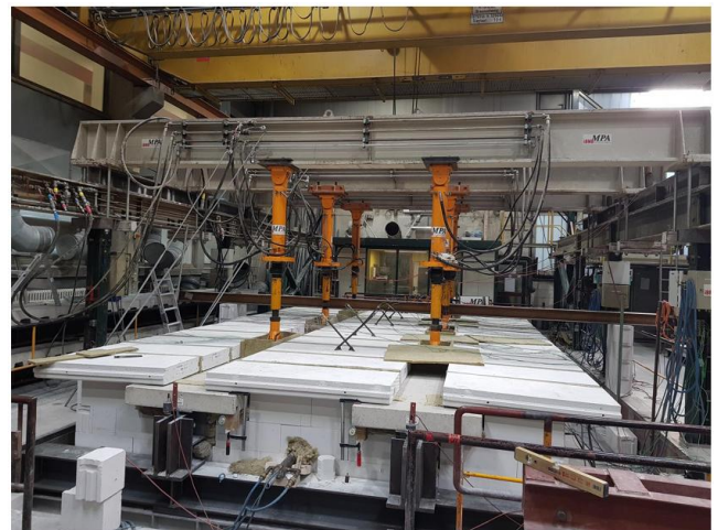
Brandversuch an mechanisch belasteten Stahlträgern
