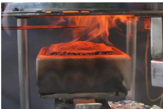
Probe im eingebauten Zustand unter Heizstrahler
