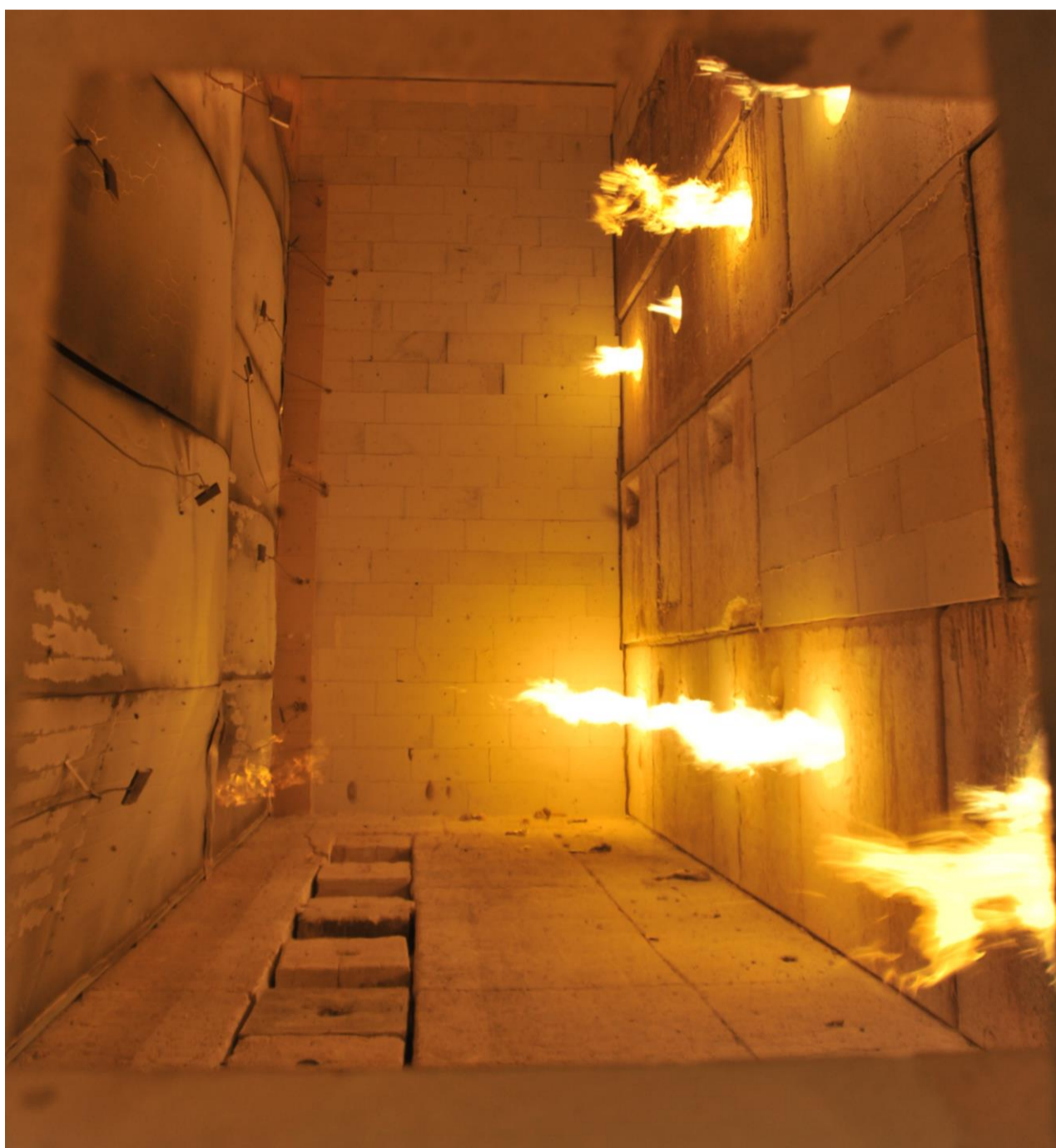
Brandversuch an einem mechanisch unbelastetem Wandaufbau aus Sandwichelementen
