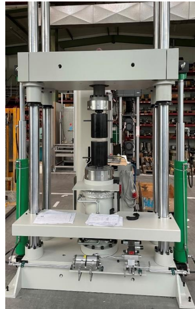
Ansicht des Heißzuganlage
