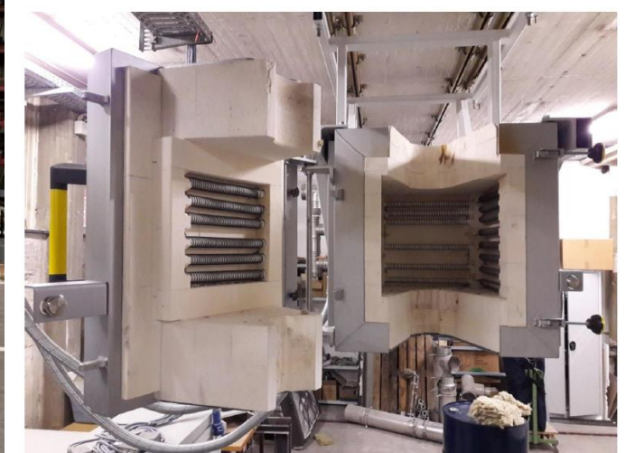
Ansicht des Elektroofens
