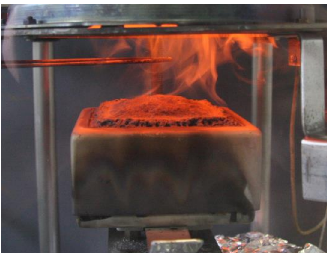
Probe im eingebauten Zustand unter Heizstrahler
