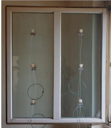
*Abbildung 2-7: Anordnung der Thermoelemente auf dem Fenster im 1. OG über dem Brandraum*
