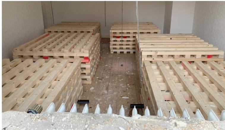
Abbildung 2-2: Anordnung der Holzrippen im Brandraum, Blick durch Fenster (V1)
