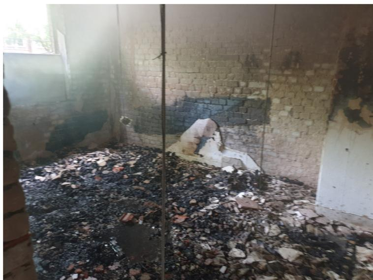
*Abbildung 3-13: Blick in den Brandraum nach Versuch 2*
