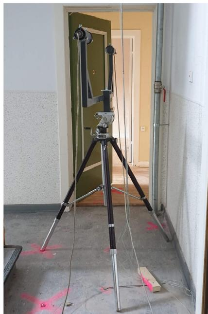
*Abbildung 2-8: Rauchmessstrecke auf dem Treppenpodest im 1. OG*
