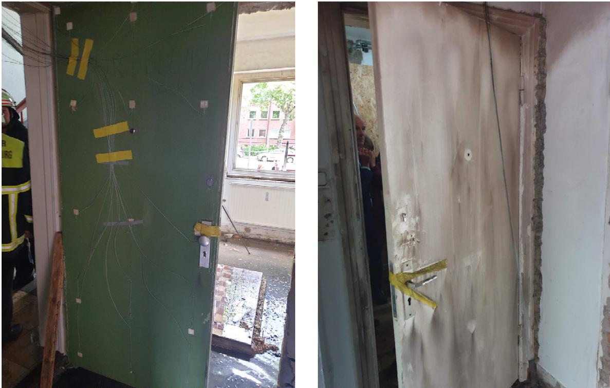
*Abbildung 3-12: Zustand der Wohnungseingangstüre nach dem Brandversuch 2, Außenseite (links) und Innenseite (rechts)*
