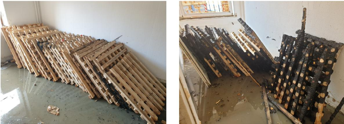
Abbildung 3-14: Unverbrannte (links) bzw. nur leicht verkohlte (rechts) Holzkippen des zweiten Versuchs
