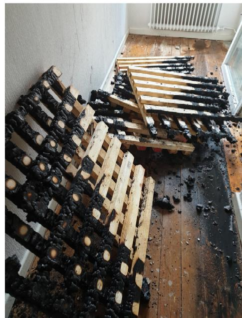
*Abbildung 3-4: Unverbrannte (links) bzw. nur leicht verkohlte (rechts) Holzkippen des ersten Versuchs*
