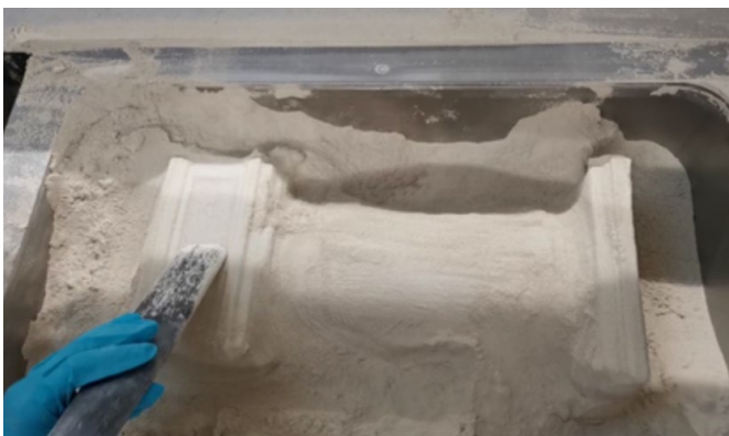
Auspacken eines gedruckten Elements aus dem nicht aktivierten Partikelbett (© TRR 277)
