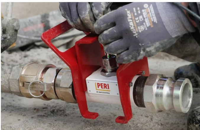
Installation in Pumpaufbau zur Kontrolle des Pumpprozesses (© PERI 3D Construction)
