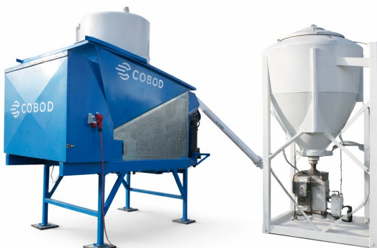
COBOD Batch Plant mit Silos für Ausgangsstoffe
