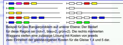
Beispiel für das Rangierproblem auf unterer Ebene: Der Bedarf für diese Region sei (rot=1, blau=2, grün=2). Die rechts markierten Waggons stellen eine zulässige Lösung mit Kosten von jeweils zwei Einheiten der gleisbezogenen Kosten für die Gleise 1,4 und 5 dar.
