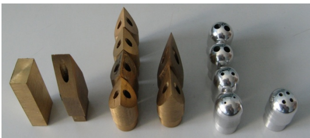
Bild 2 Varianten von verwendeten Sensorköpfen zur experimentellen Bestimmung ihrer aerodynamischen Eigenschaften.
