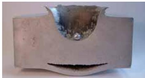
*Einschlagkrater einer 1,2 cm Aluminiumkugel mit 6,8 km/s in einen massiven Aluminiumblock.
