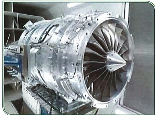
INFRa-Rig im Windkanal während der Installation
