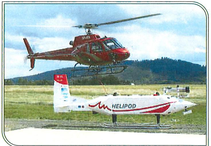
HELiPOD wird mit einem Seil vom Hubschrauber geschleppt.
