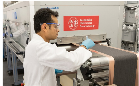
Beschichtung einer Anode an der Battery LabFactory (BLB) der TU Braunschweig. Bildnachweis: Marisol Glasserman/TU Braunschweig
