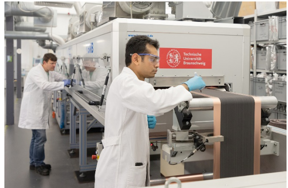
Kontinuierliche Elektrodenherstellung. Bildnachweis: Marisol Glasserman/TU Braunschweig
