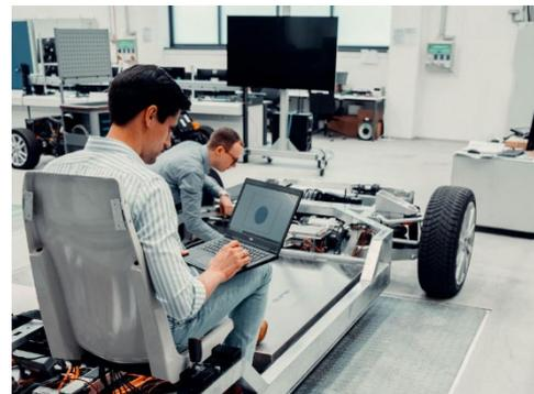
*Auf Basis des „Motionboards“ soll mit dem Projekt VanAssist ein erster Prototyp für ein autonom fahrendes Zustellfahrzeug entwickelt werden, mit dem zukünftig eine lokal emissionsfreie Paketzustellung möglich sein könnte. Mit dem Einbau der Sensorik und der Steuerungstechnik in den Basisaufbau des autonomen Elektrofahrzeugs startet das Projekt jetzt in die Praxisphase.
