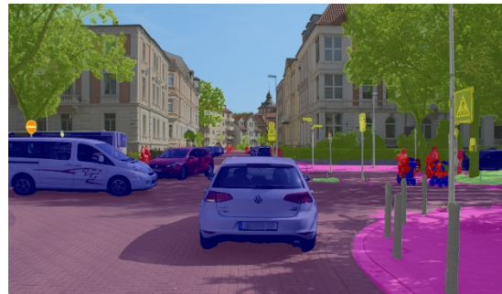
Die semantische Segmentierung ist ein intelligentes, künstlich gelerntes Bildverarbeitungsverfahren: Es sorgt für die maschinelle Wahrnehmung im Straßenverkehr. Objekte im Bild werden pixelgenau identifiziert und als Fahrzeug oder Fußgänger erkannt. Bildnachweis: IFN/TU Braunschweig
