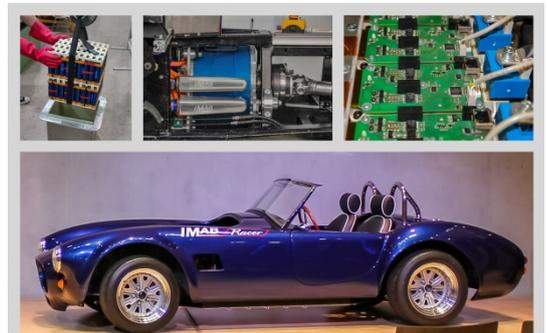
Antriebsstrangkomponenten mit Traktionsbatterie, -motor und Wechselrichter des IMAB-Racers sowie das Gesamtfahrzeug. Bildnachweis: IMAB/TU Braunschweig
