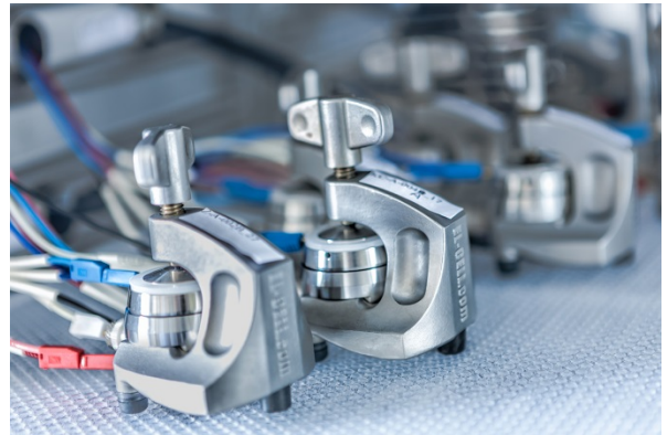
Kleinformatige Testzellen zur Untersuchung von Lithium-Ionen- und Festelektrolyt-Batterien im Labor. Bildnachweis: Hanno Keppel/TU Braunschweig
