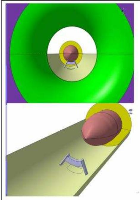
Figure 10: “Wirbel-Blende” or vortex generator
