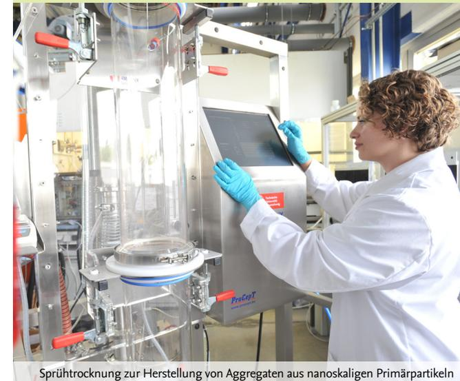
Sprühtrocknung zur Herstellung von Aggregaten aus nanoskaligen Primärpartikeln
