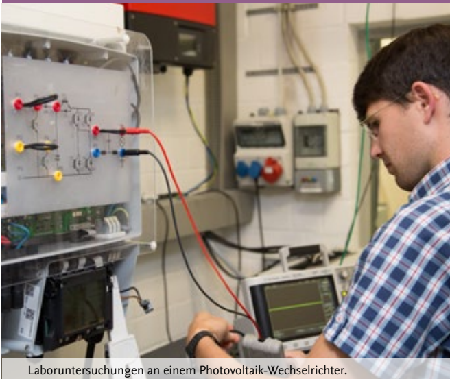
Laboruntersuchungen an einem Photovoltaik-Wechselrichter.
